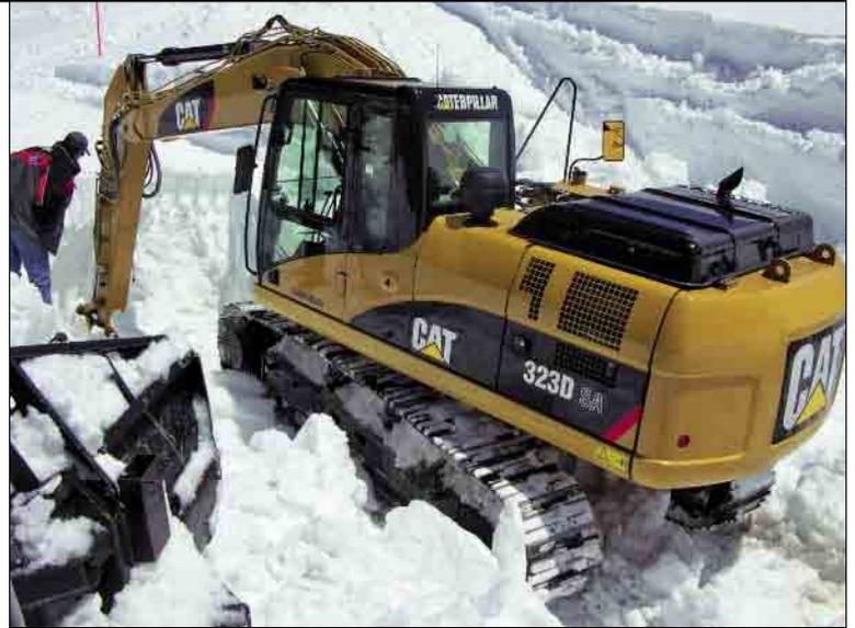
**Train de roulement.** Le train de roulement de la 323D SA se compose de deux châssis porteurs 325D. Cette solution est idéale lorsqu'il faut pouvoir compter sur une robustesse à toute épreuve, sans pour autant compromettre la facilité de transport.
