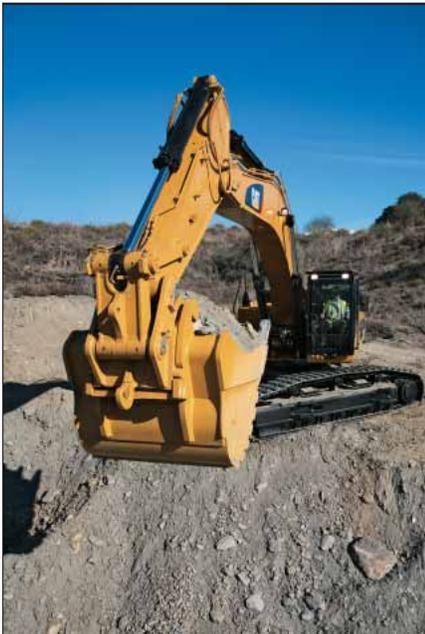
**Émissions.** Doté de la technologie ACERT qui réduit les émissions, le Moteur C13 permet de diminuer les coûts d'entretien grâce à une diminution de l'usure du moteur et à une consommation d'huile réduite. Le moteur peut en outre utiliser du biodiesel (jusqu'à B30) pour réduire encore plus les émissions sur le chantier.
