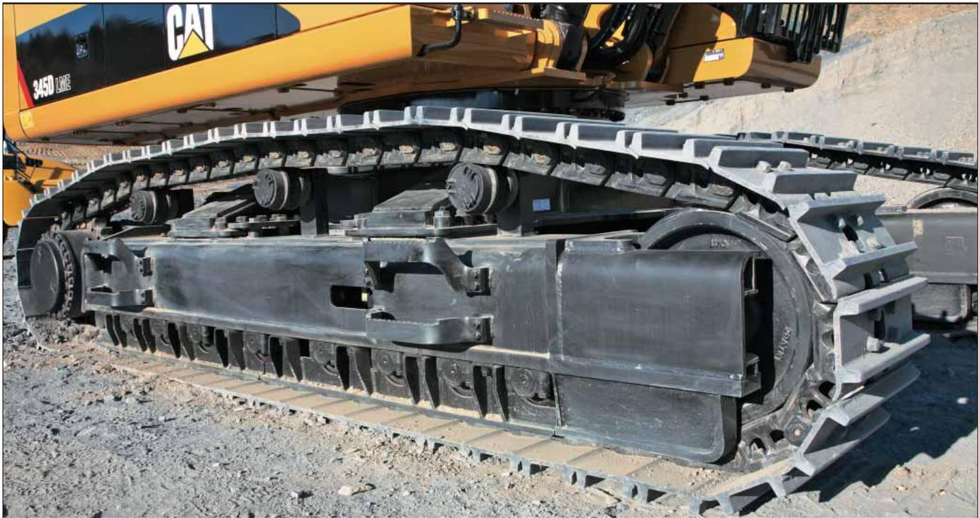
**Options de train de roulement.** La 345D L est équipée de série des nouvelles chaînes lubrifiées par graisse GLT4. Les maillons de la chaîne sont assemblés et lubrifiés par graisse pour diminuer l'usure interne de la bague, diminuer le bruit et réduire les frais d'exploitation en prolongeant la durée de service. Des chaînes à bagues de retenue série 2 (PPR2) et des roues libres moulées sont proposées comme accessoires pour la 345D L.
