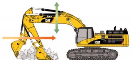
**Décapage des sols rocheux.** Le décapage des sols rocheux et les travaux de finition sont simples et rapides. La flèche flottante SmartBoom™ simplifie les opérations en permettant au conducteur de se concentrer entièrement sur le maniement du bras et du godet, tandis que la flèche peut se lever et se baisser librement sans faire appel au débit de la pompe d'équipement.
