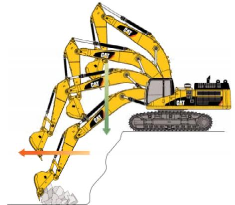
**Chargement de tombereaux.** La flèche flottante SmartBoom permet un chargement des tombereaux par reprise au tas plus productif et plus rentable en termes de consommation de carburant car le cycle de retour est réduit, la fonction d'abaissement de la flèche n'exigeant pas de débit de la pompe d'équipement.
