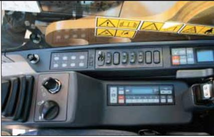
**Consoles.** Les consoles, simples et fonctionnelles, ménagent le conducteur, facilitent le maniement des commandes et procurent une excellente visibilité. Les deux consoles sont équipées d'accoudoirs réglables en hauteur.
