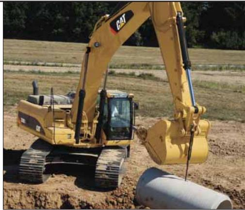
**Mode levage de charges lourdes.** Ce mode permet d'optimiser les performances de levage et d'augmenter la capacité de levage. Il est ainsi possible de déplacer de lourdes charges sur l'ensemble de la plage de travail de la machine en conservant une excellente stabilité.
