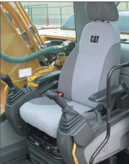
**Consoles.** Les consoles redessinées, simples et fonctionnelles, ménagent le conducteur, facilitent le maniement des commandes et procurent une excellente visibilité. Les deux consoles sont équipées d'accoudoirs réglables en hauteur.
