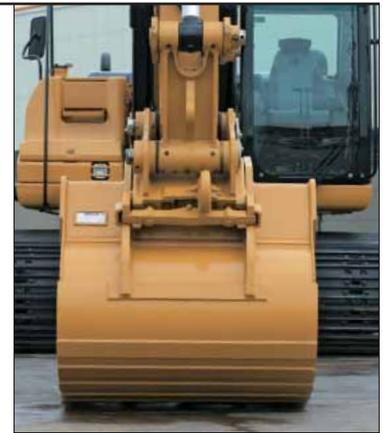
**Bras normaux avec flèche à géométrie variable.** Les bras de 3900, 3200, 2800 et 2150 mm offrent la capacité nécessaire aux applications de creusement, de levage et de martelage grâce à leur flèche à géométrie variable.
