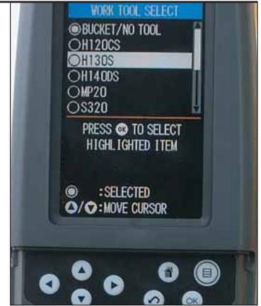
**Système de commande électronique.** Dix niveaux de débit et de pression peuvent être préenregistrés, de sorte qu'il n'est plus nécessaire de régler l'hydraulique à chaque changement d'outils.
