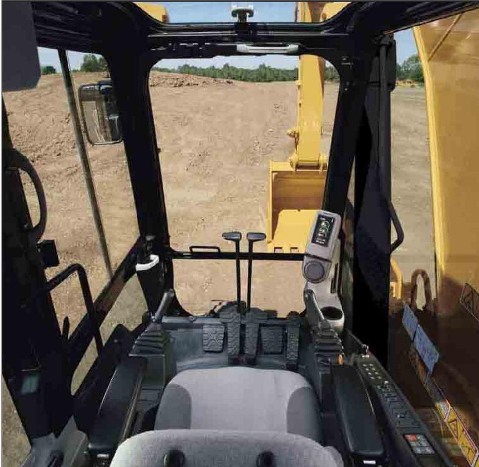
**Poste de conduite.** Le poste de travail, spacieux, calme et confortable, garantit une productivité élevée pendant une longue journée de travail. Les contacteurs des outils et du climatiseur sont placés dans un endroit pratique sur la paroi de droite, avec le contact et le cadran de la commande d'accélération situés sur la console droite. Le moniteur est facile à voir et optimise la visibilité.
