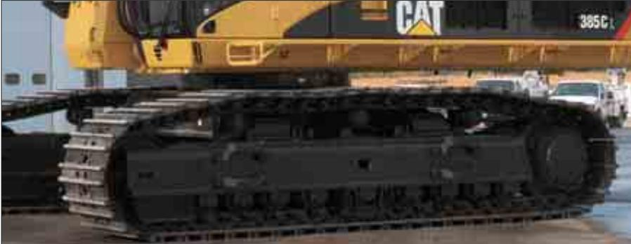
**Chaînes.** Les modèles 385C et 385C L sont livrés de série avec les nouvelles chaînes lubrifiées par graisse GLT4. Les maillons de chaîne sont assemblés et lubrifiés par graisse pour diminuer l'usure interne de la bague, réduire le bruit, prolonger la durée de service et donc abaisser les frais d'exploitation.
