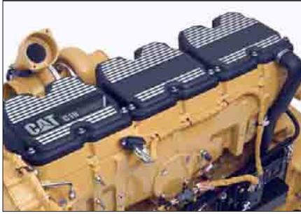
**Moteur diesel.** Le C18 Caterpillar, équipé de la technologie ACERT, est un 18,1 litres à six cylindres d'une puissance de 390 kW (530 ch) avec injection électronique à action mécanique (MEUI) et arbre à cames en tête. La technologie ACERT procure des performances exceptionnelles du moteur grâce à la commande électronique de pointe, à la précision de l'alimentation en carburant et à la gestion perfectionnée de l'air.
