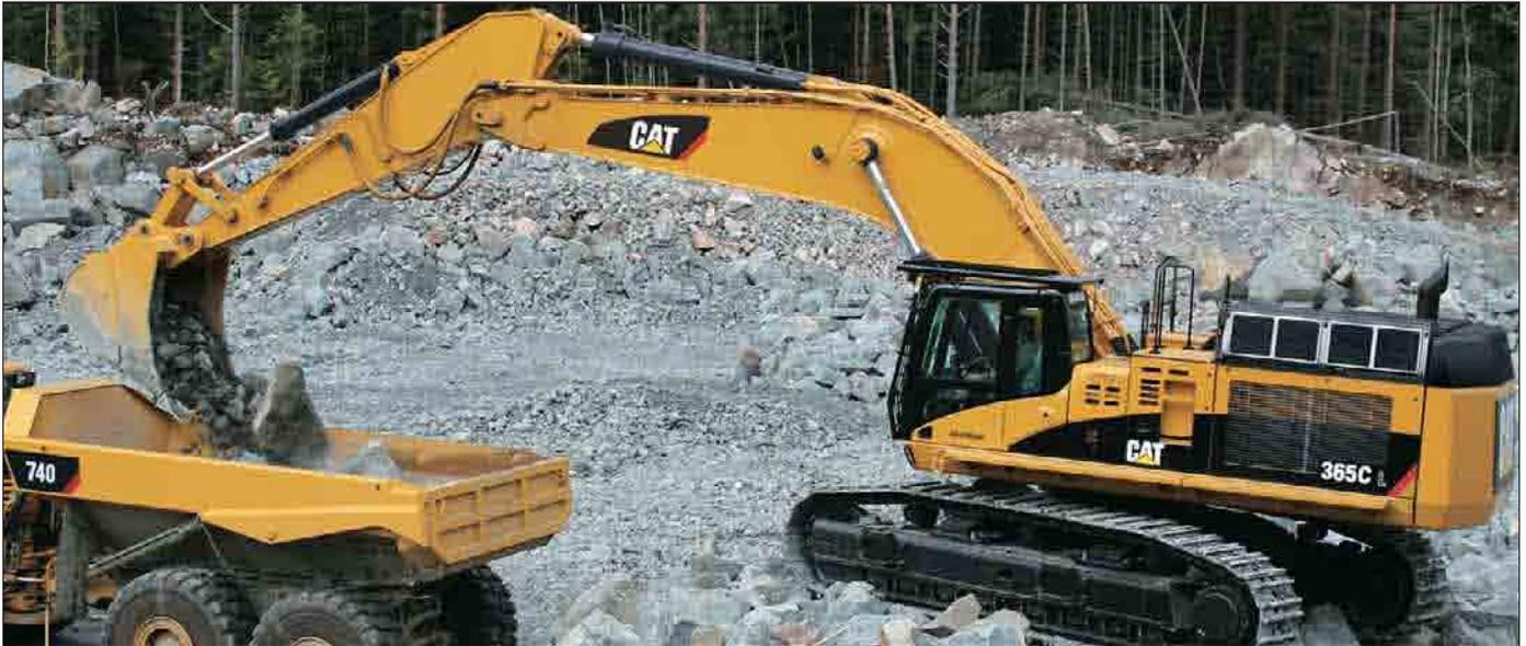
**Construite pour des applications très dures.** Avec un poids en ordre de marche de 67 à 72 tonnes, la 365C L vient s'intercaler parfaitement dans l'offre Caterpillar entre la 345C L et la 385C. La 365C L est la machine idéale pour travailler au chargement de tombereaux, sur les grands chantiers, dans les carrières et les mines ainsi que dans la manutention de matériau et la démolition.
