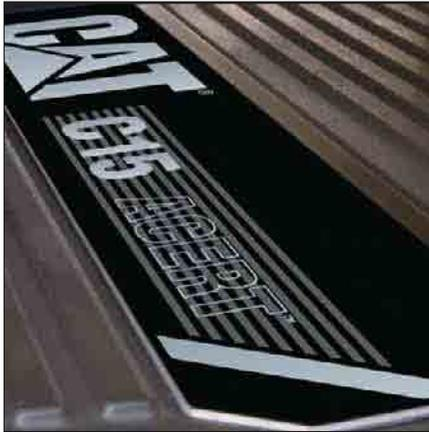
**Moteur diesel.** Le C15 Caterpillar, avec technologie ACERT, est un six cylindres de 15,2 l et 302 kW, à injecteurs-pompes électroniques actionnés mécaniquement (MEUI) et à arbre à cames en tête. La technologie ACERT procure des performances exceptionnelles du moteur grâce à la commande électronique de pointe, à la précision de l'alimentation en carburant et à la gestion perfectionnée de l'air.
