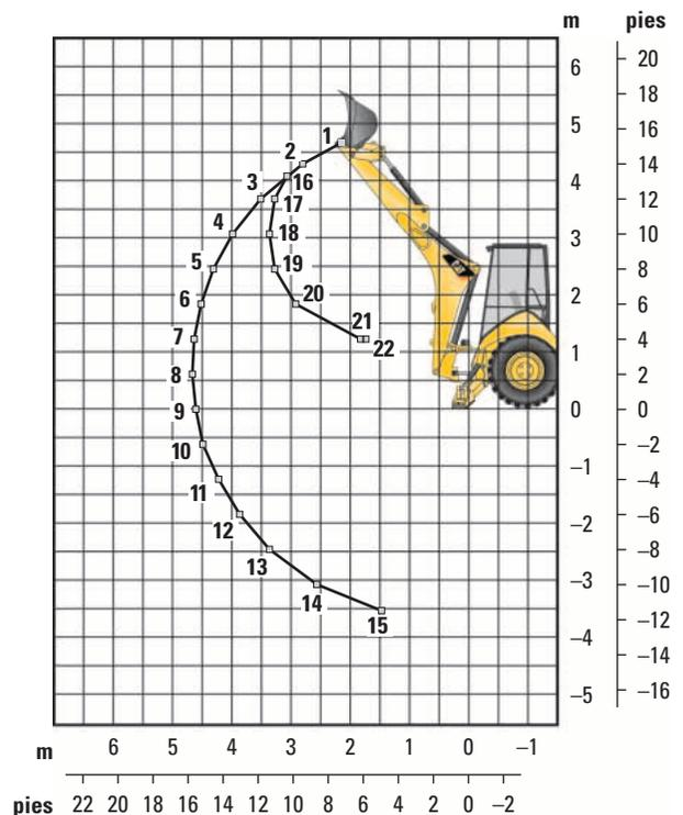
Las capacidades de levantamiento son valores sobre el extremo. Máquina equipada con tracción en 4 ruedas, estructura OROPS (estructura abierta de protección antivuelco), cucharón de uso general de 0,76 m<sup>3</sup> (1,0 yd<sup>3</sup>) y contrapeso de 116 kg (255 lb).
