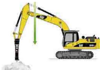
**Applicazioni con martello.** In quanto il braccio segue automaticamente il martello mentre questo avanza nella roccia. I colpi a vuoto o l'eccessivo carico sul martello sono evitati, assicurando così una maggiore durata a martello e macchina. Vantaggi simili si ottengono in caso di uso di piastre compatte.
