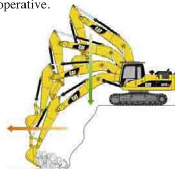
**Carico su camion.** Nella classica applicazione di carico su camion, la possibilità di tornare in fase di scavo con il braccio flottante (abbassamento per peso proprio), permette di avere a disposizione una maggior portata di olio utilizzabile per altre funzioni, a tutto vantaggio di una riduzione dei tempi di ciclo.
