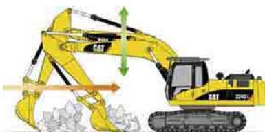
**Décapage des sols rocheux.** Le décapage des sols rocheux et les travaux de finition sont simples et rapides. Outre une simplification du travail, la flèche SmartBoom permet au conducteur de se concentrer sur le bras et le godet tandis que la flèche monte et descend librement sans solliciter le débit des pompes.
