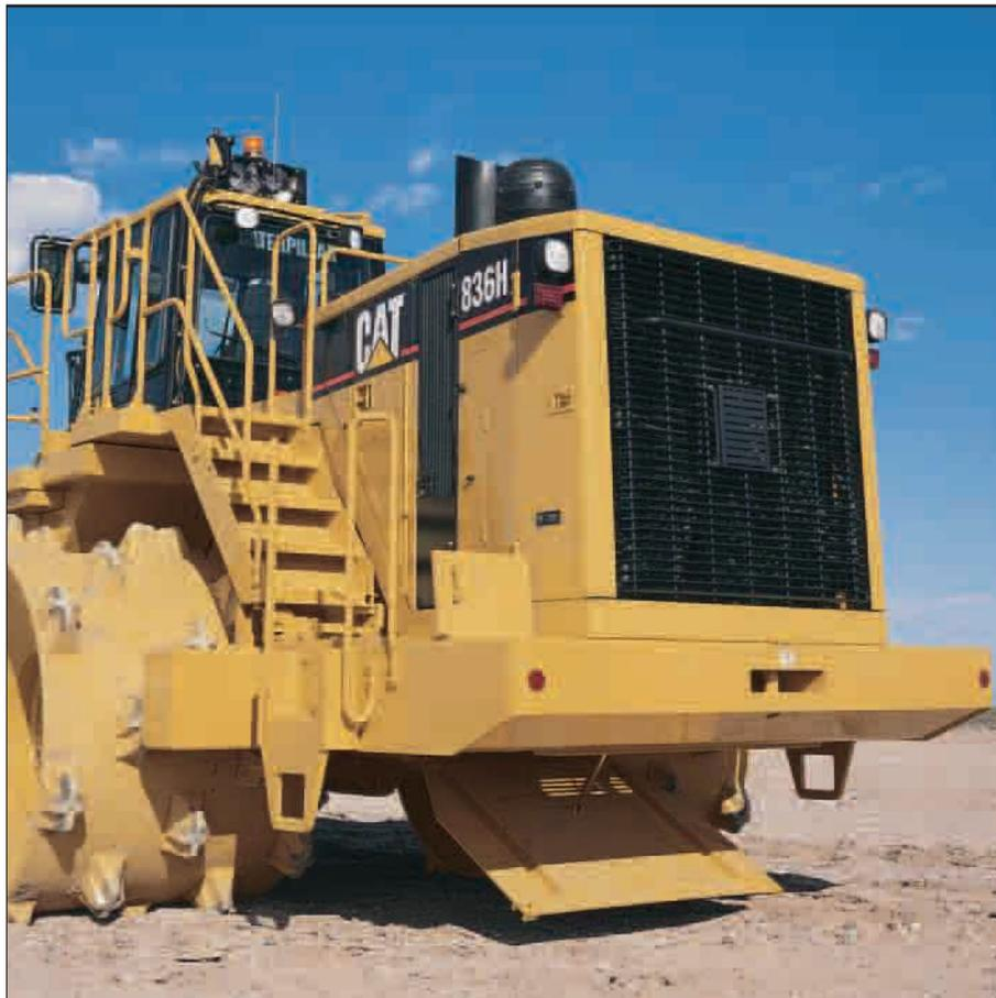
**Sistema di raffreddamento e ventola separati.** Il sistema di raffreddamento e la ventola separati sono specificamente realizzati per operare nel difficile ambiente; un dispositivo inverte il senso di rotazione della ventola per pulire le masse radianti con facilità e continuità. Il sistema contribuisce inoltre a ridurre i costi operativi ed a migliorare la capacità di raffreddamento.
