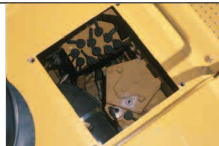
**Facilità d'accesso.** I punti di manutenzione sono facilmente raggiungibili, comprese le prese rapide per il controllo delle pressioni delle frizioni della trasmissione (ECPC) adesso posizionate dietro la cabina, sotto la piattaforma.
