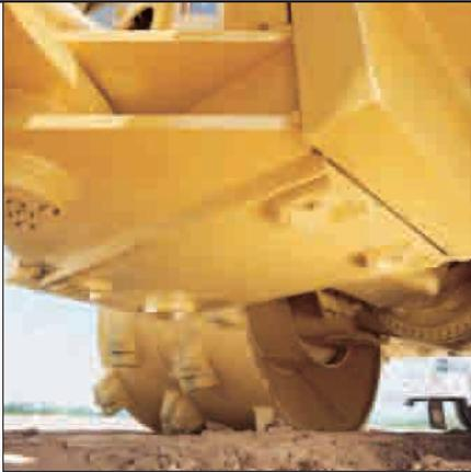
**Protezione bulloni.** Le protezioni dei bulloni, nel lato inferiore della macchina, ne evitano usure premature.
