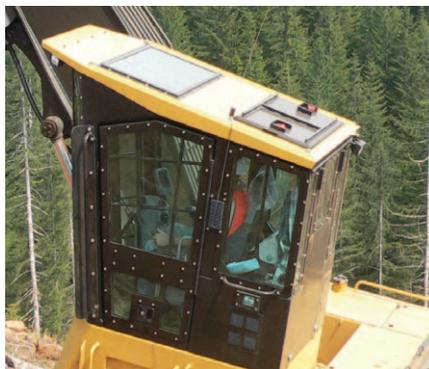
**Cabine forestière d'usine.** La cabine FOPS conçue et construite en usine par Caterpillar pour la foresterie comporte des options de protection du pare-brise et des vitres afin de répondre aux exigences de protection locales. Les vitres de droite et arrière sont faites de polycarbonate résistant aux chocs.
