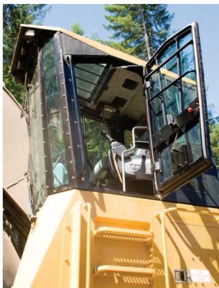
**Poste de conduite.** La cabine de conduite est spacieuse, calme et confortable, assurant ainsi une productivité supérieure pendant une longue journée de travail. Les commandes, les manipulateurs et un siège de conception ergonomique réduisent la fatigue du conducteur.
