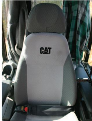
**Siège.** Le siège offre une variété de réglages pour convenir à la taille et au poids du conducteur, y compris d'avant en arrière, en hauteur et selon le poids. De larges accoudoirs réglables et une ceinture de sécurité à enrouleur sont aussi inclus.
