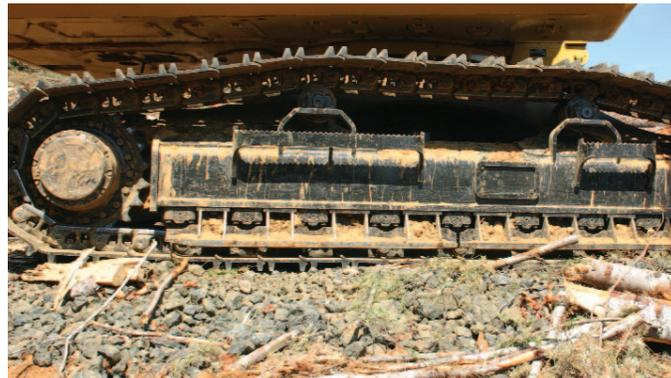
**Galets supérieurs extra-robustes.** Des galets inférieurs avec supports doubles remplacent les galets supérieurs pour assurer une résistance supérieure.
