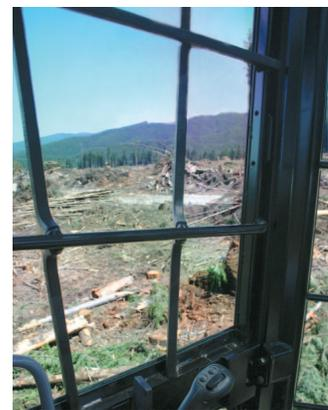
**Visibilité.** La conception de la cabine optimise la structure des montants et le positionnement des vitres en polycarbonate résistant aux rayures pour offrir au conducteur une excellente visibilité sur l'avant, les côtés et l'arrière. La cabine forestière est conçue avec des blindages extra-robustes et répond aux exigences FOPS/OPS/FOGS/TOPS et CB.
