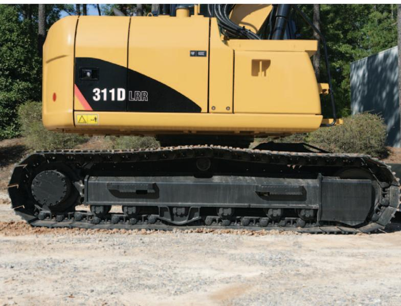
A Caterpillar utiliza programas e engenharia avançadas para analisar todas as estruturas, criando uma máquina durável e confiável para as aplicações mais rigorosas. Mais de 70% das soldas estruturais são robóticas e de maior penetração do que as soldas manuais. Esses componentes estruturais e o material rodante são a “espinha dorsal” da durabilidade da máquina.
