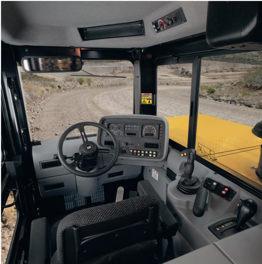
**Suspensão do Assento.** A nova suspensão do assento padrão é equipada com um amortecedor de choque a ar de alto desempenho com compressão de ar independente. Para os operadores exigindo amortecimento adicional, os amortecedores de choque duplos na suspensão do assento estão disponíveis.
