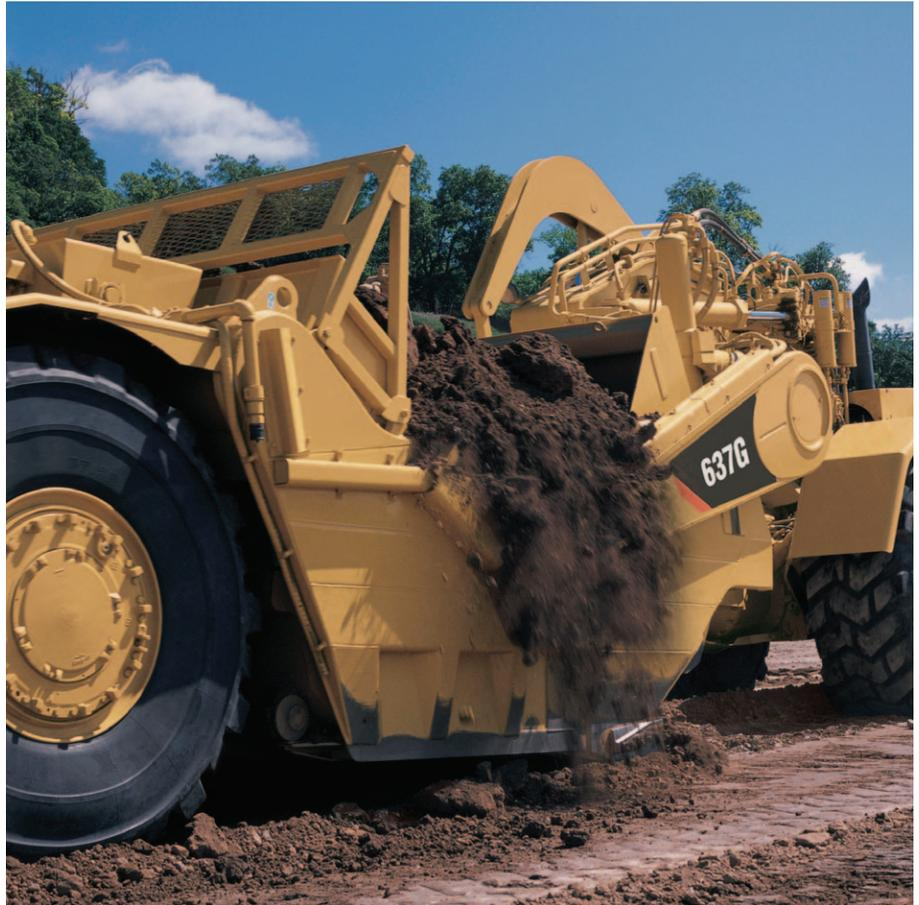
**Motor Tandem.** Dois motores asseguram potência para escalar rampas íngremes e torna possível a tração em todas as rodas para enfrentar condições de solo escorregadias, lisas.
