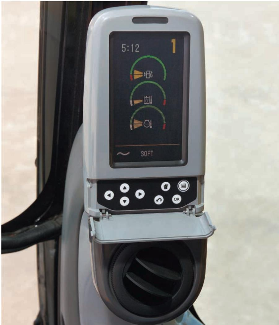
**Tela de exibição do monitor.** O monitor é uma tela gráfica totalmente colorida de 400 × 234 pixels em Cristal Líquido (LCD).
