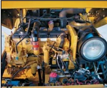
带有辅助动力的发动机罩可以全幅打开，为发动机、空滤器、液压部件和其它日常保养点提供方便的接近通道。
