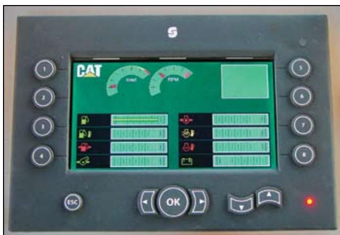
双操作控制台。控制器和仪表布置整齐，使用方便。所有的仪表和显示屏，即便在阳光直接照射下，都很容易看清。
