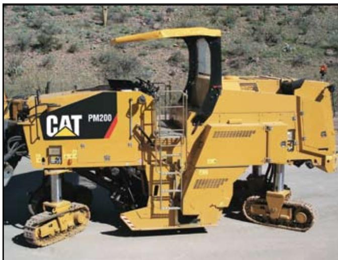
四种转向模式。在狭窄的工作场合，转向控制装置提供四种转向模式：前履带转向，蟹行转向，原地转向和后履带转向。
