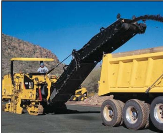
**液压折叠式皮带机。**只要将皮带机向上液压折叠，就可减少机器尺寸，便于机器运输。
