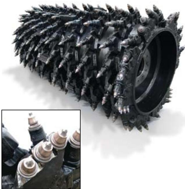
**178 把硬质合金刀头。**刀头安装在牢固的、三段式、可快速更换的刀柄内，并以三联排螺旋形结构布置，可获得极大的铣削力。带有锥度的可快速更换锥形刀柄与刀座始终保持紧密的固定。
