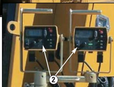
接触式或非接触式纵坡传感器。传感器可安装在机器的任意一侧，具有相同的精确度。横坡传感器进一步增强系统的多用性。
