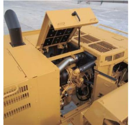
**排放。**ACERT 技术的非凡之处在于显著降低了燃烧过程中的废气排放。此项技术成就了卡特彼勒公认的领先地位，为以下三个核心发动机系统提供了突破性技术：燃油、空气和电子系统。
