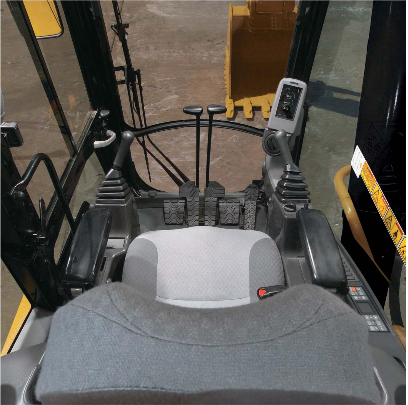
**驾驶室设计。**工作台的设计宽敞、安静而且舒适。操作员舒适性与一流的视野可在整个工作日内始终确保高效生产率。监控器和开关布置便利，触手可及，清晰易读。
