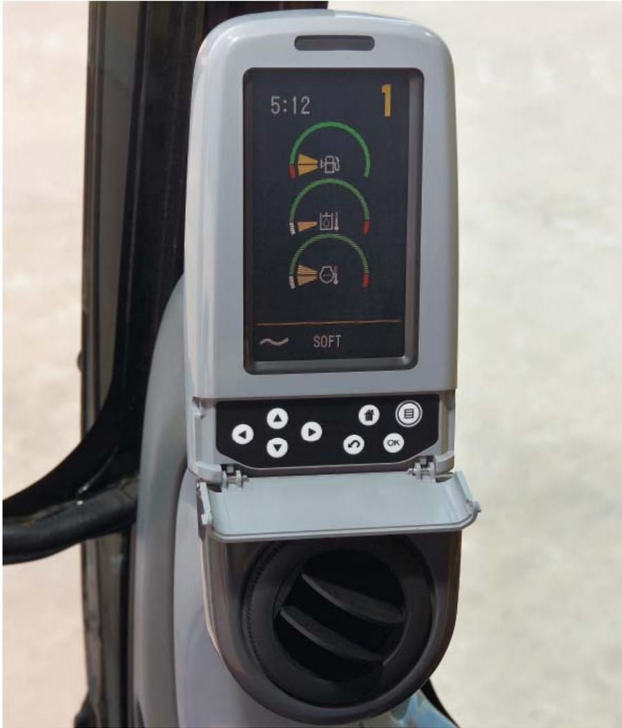
**监控器显示屏。** 监控器为 400 x 234 像素全彩色液晶 (LCD) 图形显示器。
