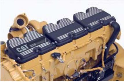
**柴油发动机。**采用 ACERT 技术的卡特彼勒 C18 是一款 18.1 升、六缸、382 kW (513 hp) 发动机，配备机械驱动电子燃油喷射 (MEUI) 和顶置凸轮轴。ACERT 技术实现选进的电子控制、精确的燃油输送和优化的空气管理，确保卓越的发动机性能。
