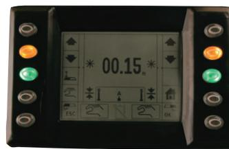
Pantalla del Sistema Láser AccuGrade
