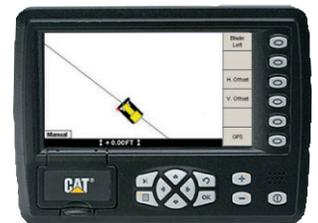
Pantalla del Sistema GPS AccuGrade
