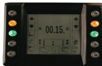
Pantalla del Sistema Láser AccuGrade
