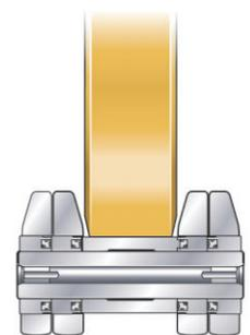
Rueda guía con rodadura central del tren de rodaje SystemOne
