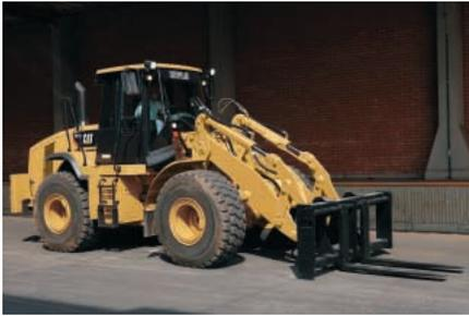
**Horquillas.** Desde horquillas para paletas hasta configuraciones especiales para trabajos forestales, se ofrecen horquillas para una gran variedad de aplicaciones.
