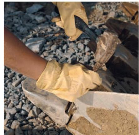
**Herramientas de corte.** Varias opciones de herramientas de corte (GET) están disponibles de Caterpillar para los cucharones del IT62H. Se ha incorporado un adaptador de esquina hecho de fundición en el diseño de los cucharones que permite colocar un diente en la esquina del extremo para proteger contra el desgaste de la base del cucharón.
