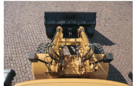
**Varillaje de 8 barras.** El varillaje proporciona levantamiento en paralelo durante todo el ciclo de levantamiento, lo cual es particularmente importante cuando se usan horquillas. El levantamiento en paralelo permite al operador concentrarse en colocar la carga, en lugar de retenerla. La visibilidad hacia la herramienta es excelente.
