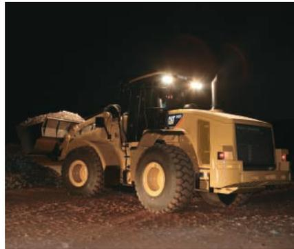
**Conjuntos de iluminación.** Se dispone de conjuntos de iluminación optativos para aplicaciones de desplazamiento por carretera o luces bajas. Las luces optativas de Descarga de Alta Densidad (HID) proporcionan una iluminación excepcional para el trabajo nocturno. Se dispone de una baliza giratoria como característica de seguridad.
