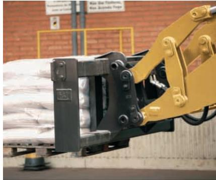
**Horquillas para paletas.** Cuando se usa con un acoplamiento rápido, las horquillas para paletas aumentan la versatilidad de la máquina. Son ideales para manipular una variedad de materiales.
