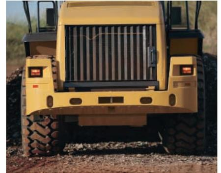
**Contrapeso.** El contrapeso de una pieza está integrado en el diseño y el estilo del IT62H. Este contrapeso de 4.389 lb (1.991 kg) incorpora las luces traseras en la parte superior de la estructura.
