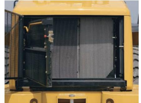
**SISTEMA DE ENFRIAMIENTO.** El acceso al sistema de enfriamiento para la limpieza y el mantenimiento es extraordinario. La parrilla perforada y corrugada reduce al mínimo la acumulación de residuos y se abre hacia afuera para facilitar la limpieza y el acceso de los núcleos de enfriamiento.
