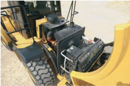
**ACCESO AL COMPARTIMIENTO DEL MOTOR.** El capó no metálico del IT62HH se ha cambiado de diseño y estilo con respecto a los modelos anteriores. Los paneles laterales y superior son más fuertes debido a las nervaduras de refuerzo más robustas – el cambio de perfil también confiere rigidez al capó.
