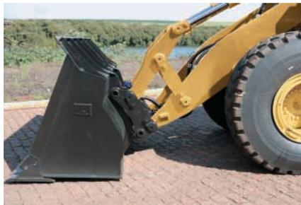
**Cucharones para manipulación de materiales.** El cucharón de manipulación de materiales es un cucharón de piso plano usado para manipular materiales apilados como áridos u otros materiales fáciles de cargar que requieran una fuerza de desprendimiento moderada.
