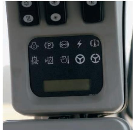
**Sistema Monitor Caterpillar.** El IT62H está equipado con el Sistema Monitor Cat (CMS) que vigila el estado de su máquina. El CMS supervisa las funciones críticas del sistema del motor y disminuirá la potencia del motor para protegerlo contra los daños si es necesario. Dependiendo de cuál de las seis siguientes condiciones críticas se presente, el monitor del CMS o el panel delantero mostrará luces de advertencia y alarmas de sonido audible.
