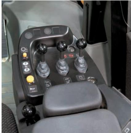
**Controles electrohidráulicos del accesorio.** Los controles electrohidráulicos del accesorio en el IT62H proporcionan al operador unas desconexiones automáticas programables en la cabina para impedir el derrame de material – aumentando la productividad. La consola de control del accesorio dispone de un interruptor optativo de avance/neutral/retroceso que permite cambios de dirección rápidos y sencillos para reducir los tiempos de los ciclos.
