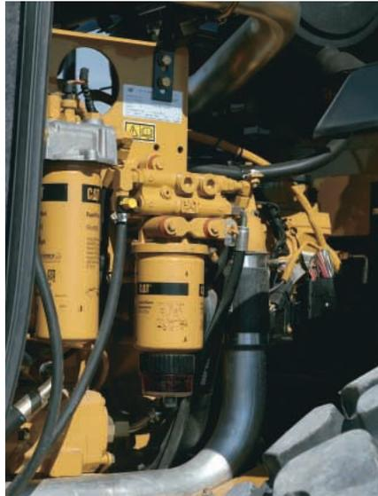
**BOMBA ELÉCTRICA DE CEBADO.** Hay una bomba eléctrica de cebado de combustible ubicada en la base del filtro de combustible principal que elimina la necesidad de llenar de forma preliminar o cebar manualmente los filtros después de un cambio, eliminando la contaminación del motor.
