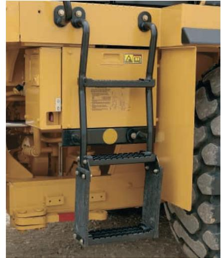
**ENTRADA Y SALIDA.** Una escalera abierta evita que se acumulen escombros en los escalones. La escalera está inclinada 5° hacia adelante para facilitar la entrada y la salida.
