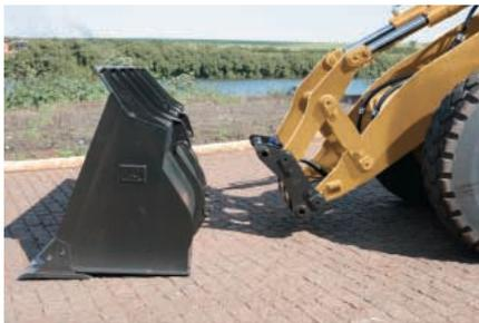
**Acopladores rápidos.** Los acopladores rápidos proporcionan una versatilidad sin igual en los cargadores de ruedas. El modelo hidráulico permite al operador cambiar de accesorios en sólo segundos sin salir de la cabina. En el modelo manual, el operador tiene que bloquear los pasadores.
