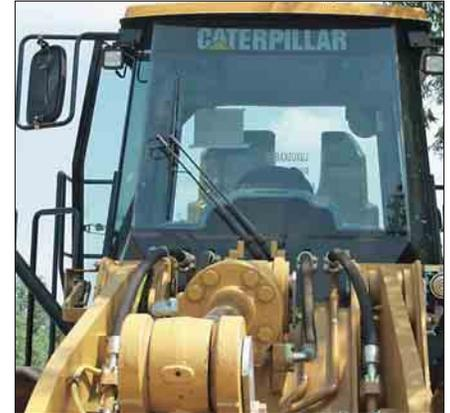
**Cabina.** A cabina de operação pode ser removida totalmente em cerca de 45 minutos e é fácil de ser reinstalada. São usados desengates rápidos, portanto nenhum fio precisa ser cortado e nenhum líquido de refrigeração é perdido. A limpeza da cabina é facilitada com canais no piso da cabina e nenhum degrau na porta – o piso pode ser varrido ou lavado facilmente.
