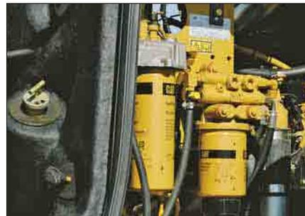
**Bomba eléctrica de ferra.** Uma bomba eléctrica de ferra de combustível localizada na base do filtro primário de combustível elimina a necessidade de enchimento prévio ou de ferra manual dos filtros depois de uma mudança, eliminando a contaminação do motor.
