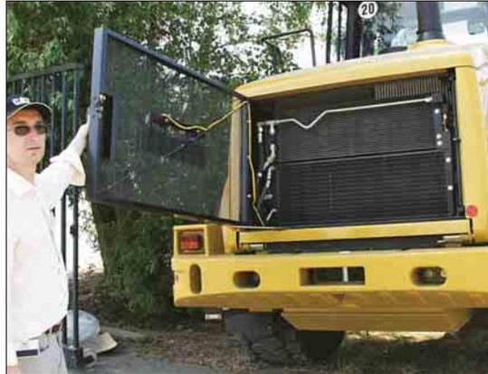
**Sistema de refrigeração.** Acesso para limpeza e manutenção é excelente. A grade perfurada e corrugada minimiza o acúmulo de detritos e articula para fora para uma limpeza fácil e acesso aos núcleos de arrefecimento. O condensador do ar condicionado e o núcleo do radiador de óleo em tamanho integral articulam 45° para permitir uma limpeza fácil da face traseira do radiador. Painéis num dos lados proporcionam acesso para a face dianteira do radiador e núcleos ATAAC para limpeza fácil.
