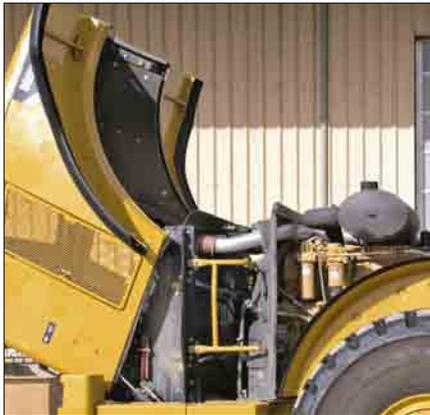
**Motorraumzugang.** Nicht nur die Kontur der Kunststoff-Motorhaube wurde verändert, sondern auch die Ober- und Seitenteile mit zusätzlichen Versteifungsrippen versehen. Beide Maßnahmen verbessern Stabilität und Dauerhaltbarkeit der Haube. Seitenklappen hinter den Reifen lassen sich hochschwenken und bei Bedarf komplett abnehmen. Die ausschwenkbaren großen Kotflügel sind hinten angelenkt und erleichtern dadurch den Zugang zum Motorraum.
