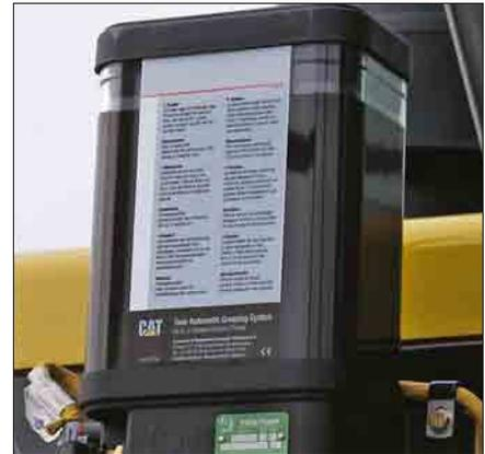
**Zentralschmieranlage.** Bei Ausrüstung mit Zentralschmierung wird automatisch die erforderliche Fettmenge in den richtigen Intervallen zu den Schmierstellen gepumpt. Gravierende Vorteile: wesentlich niedrigere Schmierkosten, geringerer Reparaturaufwand, größere Sicherheit und erhöhter Umweltschutz.
