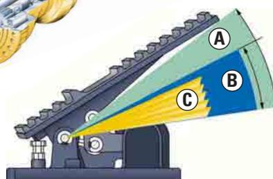
**Integralbremse.** Das exklusive Cat Integralbremssystem IBS (Integrated Braking System) senkt die Achsöltemperaturen und bewirkt eine ruckarme Getriebeneutralisierung. IBS sorgt vornehmlich bei Load-and-Carry-Einsätzen mit längeren Fahr- und Gefällestrecken für optimale Standzeiten der Achsen und Bremsen.
