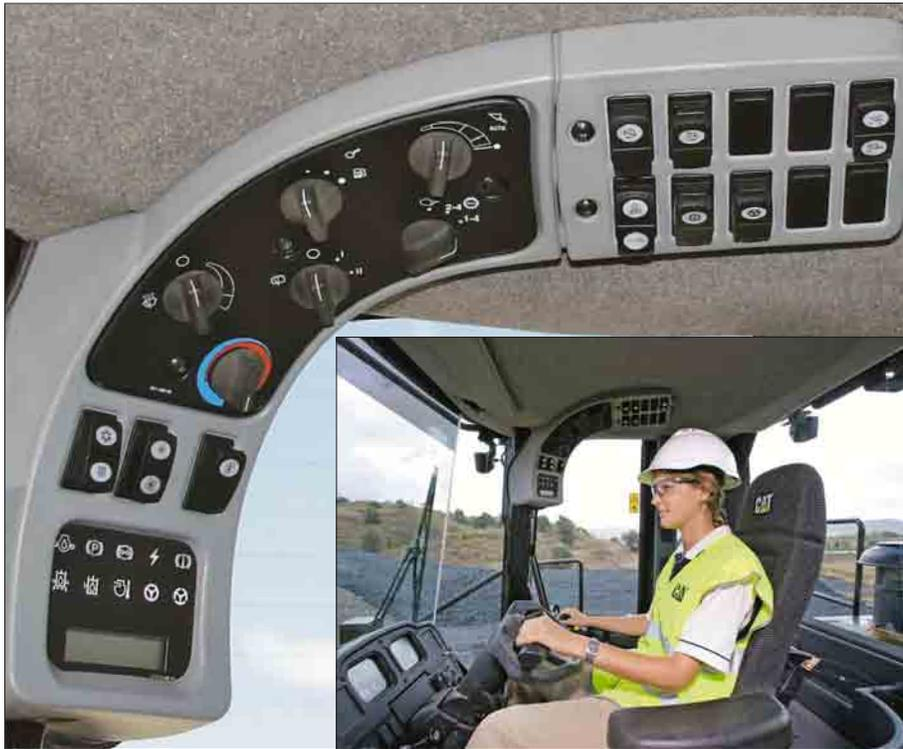
**Schalttafel.** Die übersichtlich gestaltete Schalttafel ist in der oberen rechten Kabinenecke an der Säule des integrierten Überrollschutzaufbaus befestigt – ein idealer Platz, denn alle Bedienelemente befinden sich in unmittelbarer Reichweite des Fahrers und zugleich wird eine Sichtbehinderung vermieden.
