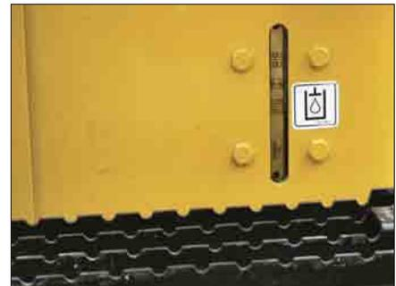
**Schaugläser.** Geschützt eingebaute, aber trotzdem leicht ablesbare Schaugläser gestatten eine schnelle Kontrolle der Getriebeöl-, Hydrauliköl- und Kühlmittelfüllstände.
