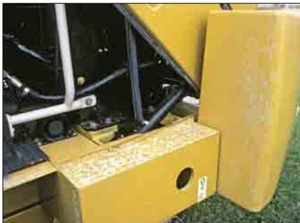
Eine elektrohydraulische Kippvorrichtung mit mechanischer Notbetätigung erlaubt ein schnelles Öffnen der Motorhaube, damit Dieselmotor und Nebenaggregate bei Bedarf frei zugänglich sind.
