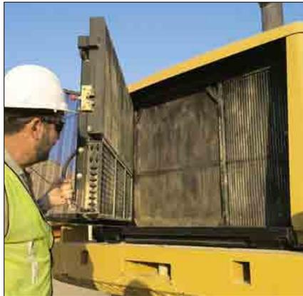
**Kühlsystem.** Ein feinmaschiges, gewelltes Siebgitter vermindert die Verstopfungsgefahr und kann zum Reinigen der Kühlernetze nach links geschwenkt werden. Kältemittel-Kondensator und Ölkühler sind mit einer 45°-Schwenkvorrichtung ausgerüstet, sodass man den dahinterliegenden Wasserkühler mühelos erreichen und säubern kann. Hinzu kommen seitliche Klappen, die den Zugang zur Vorderseite von Wasserkühler und Ladeluftkühler zusätzlich erleichtern.
