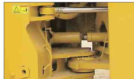
**Knickgelenk.** Die stark gespreizte Konstruktionsform des Knickgelenks reduziert nicht nur die Lagerbelastung, sondern schafft auch viel Platz für Servicearbeiten. Obere und untere Doppelkegelrollenlager nehmen die vertikalen und horizontalen Kräfte auf und verteilen sie auf eine große Kontaktfläche.
