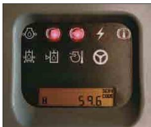
**Überwachungssystem CMS.** Alle wichtigen Maschinenfunktionen werden ständig vom elektronischen Überwachungssystem CMS (Caterpillar Monitoring System) kontrolliert. Falls erforderlich, drosselt CMS automatisch die Motorleistung, um durch Funktions- oder Wartungsfehler verursachte Folgeschäden weitgehend zu vermeiden. Bei gravierenden Störungen werden die jeweilige Kontrollleuchte und ggf. ein Warnsignal aktiviert:
