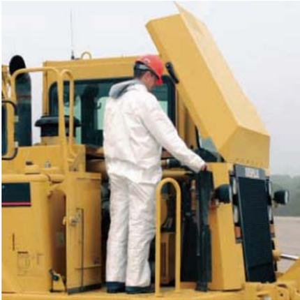
维修点集中在一起。发动机的保养和维修点都集中在右手侧，易于检修。其中包括发动机空气滤清器、发动机机油检查和加注口、燃油滤清器和注油口，冷却液液位观察孔、车窗清洗器液罐、空调机干燥器罐，乙醚起动辅助液罐、发动机机油滤清器、风扇驱动润滑装置，和发动机机油和冷却液的取样口。
