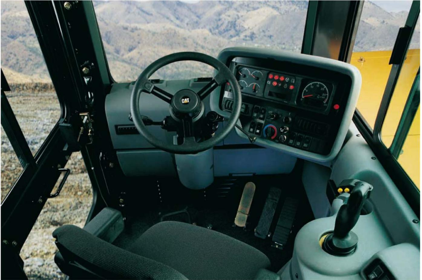
**多向调节座椅。**卡特彼勒舒适型布面座椅为可调座椅，并配有扶手，以获得最佳的操作舒适性。
