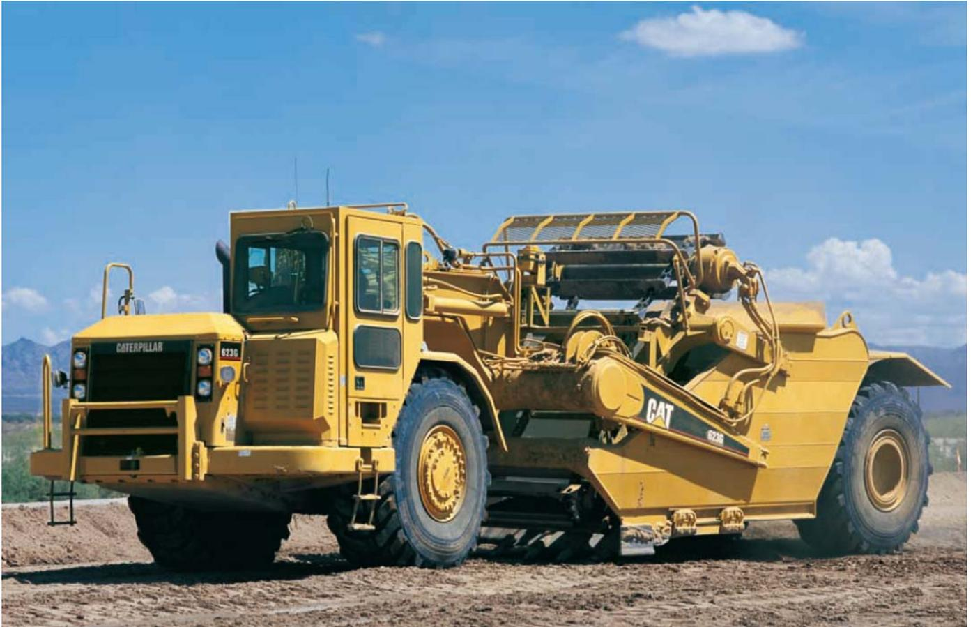
**重新设计的铲运斗。**斗容增加了10%，改进了牵引臂保护，并具有更好的物料保持能力，因此具有出色的生产效率。低断面铲运斗设计对进入的物料阻力较小，而格形构造铲运斗结构强度更高，侧板和底板不易产生凹陷。
