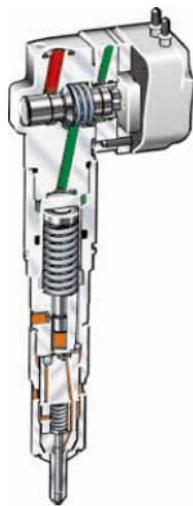
**电子单体喷油 (EUI)。**在发动机整个工作范围内，电子喷射能全面控制变工况下的喷射正时、持续时间、喷射速率和压力。**EUI** 控制的发动机提供：
