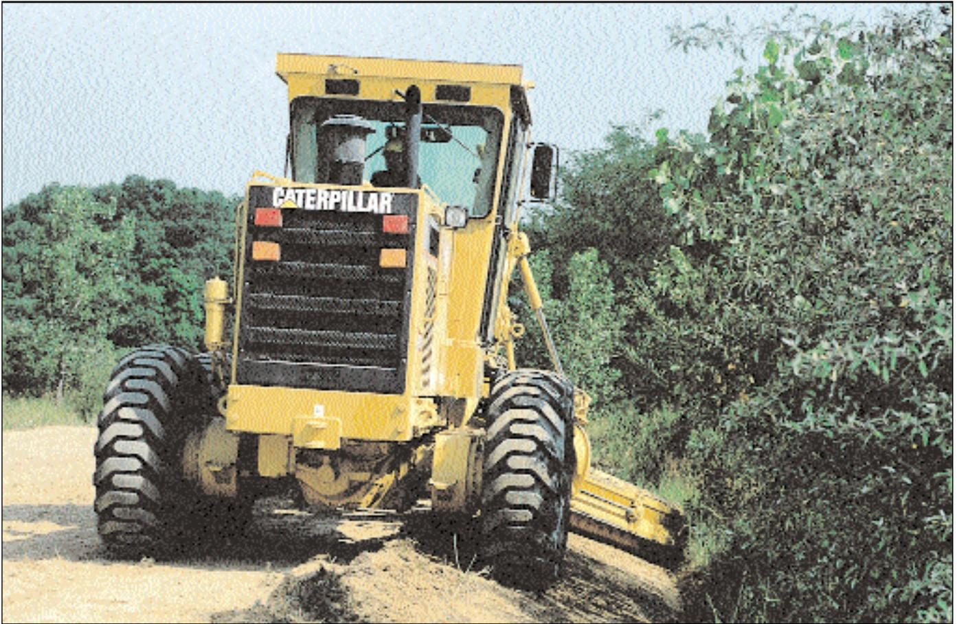
**Posicionamento de Lâmina.** O projeto da sela da lâmina proporciona melhor posicionamento. Este maior alcance é principalmente utilizado em taludes de inclinação média e em corte e limpeza de valetas.
