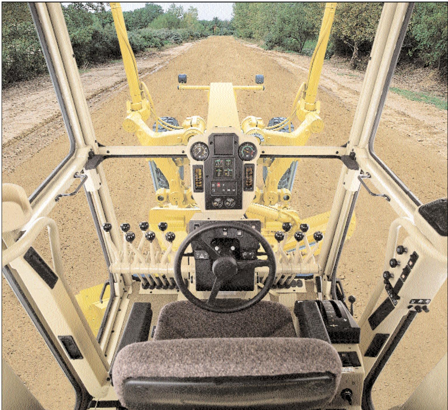
**Visibilidade excepcional** auxilia o operador a melhorar sua confiança e produtividade em todas as aplicações de motoniveladoras. A barra de tração foi modificada para melhorar a visibilidade através do círculo permitindo que o operador veja o material rolando ao longo da lâmina sem se enclinar. Largas janelas laterais oferecem visão clara da ponta da lâmina e pneus traseiros. O vidro traseiro mais largo e um capô afilado fornecem ótima visibilidade traseira, especialmente para o ríper.
