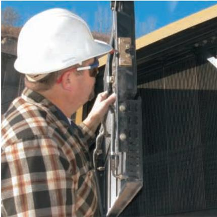
**Arrefecimento.** As colméias do radiador modular de nova geração (NGMR) têm projeto modular permitindo a substituição de uma única colmeia sem remover todo o radiador – reduzindo os custos dos reparos e o tempo de máquina parada. Um visor de nível localizado no tanque shunt permite verificações rápidas de manutenção. As grades perforadas, corrugadas basculam para fora para fácil acesso às colméias de arrefecimento.
