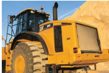
**Novo capô.** Um novo capô foi projetado para a 980H. Com a espessura de duas camadas, o novo capô proporciona maior durabilidade enquanto mantém a visibilidade para o solo. O capô reforçado é mais resistente ao vento e ao acúmulo de barro. O sistema de acionamento também foi melhorado. Cilindros duplos de elevação acionados eletro-hidraulicamente reduzem de forma significativa o tempo de elevação e de descida.
