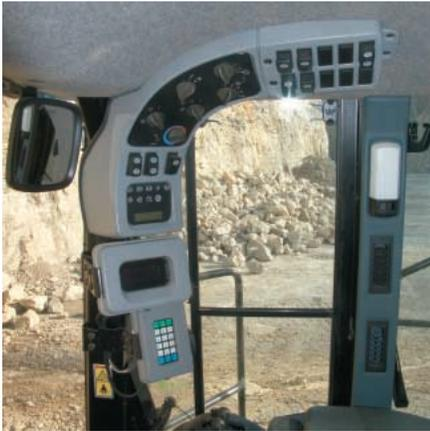
**Sistemas integrados.** O Sistema de Monitorização Eletrônica (EMS) rastreia os sistemas críticos da máquina para alertar o operador sobre a necessidade potencial de manutenção. Quatro níveis de alerta permitem que o operador avalie a situação com maior precisão. O EMS é conectado ao motor, à transmissão, ao sistema hidráulico e aos freios – conectando todos os principais sistemas e permitindo que a carregadeira trabalhe como um sistema totalmente integrado – desde a articulação até o motor.
