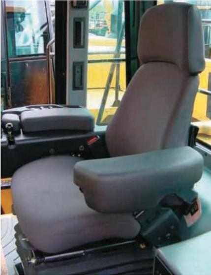
**Assentos.** O assento da Série Comfort C-500 Caterpillar é fabricado forte e durável e é ajustável em 6 posições para acomodar operadores de todos os tamanhos. Encosto e assento fundidos em uma peça evitam as saliências sob as almofadas. O assento tem um suporte lombar do tipo automobilístico para máximo conforto. O apoio de braço direito com controles de implementos integrado se ajusta para uma operação conveniente confortável.
