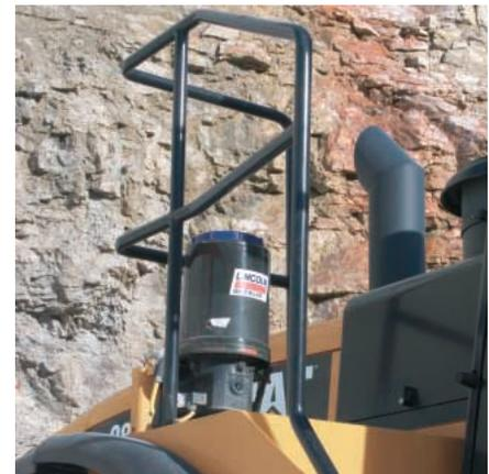
**Autolube.** Agora disponível como opção instalada de fábrica, o sistema de lubrificação automática opcional proporciona uma lubrificação precisa, automática dos pinos e das buchas – enquanto a máquina está em operação. A lubrificação com a máquina em movimento reduz o tempo de máquina parada planejado, a manutenção diária e os reparos custosos.
