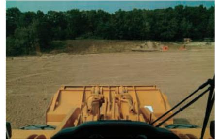
**Visibilidade.** A 980H proporciona excelente visibilidade para a dianteira e a traseira da máquina. Vidros planos livres de distorções se estendem até o solo da cabine para excelente visibilidade para a caçamba. Limpadores de vidros tanto na dianteira como na traseira mantêm os vidros limpos em qualquer condição. O teto da cabine tem canaletas que dirigem a chuva para fora dos cantos da cabine mantendo os vidros livres. Uma borda em toda a volta protege o operador contra o ofuscamento.
