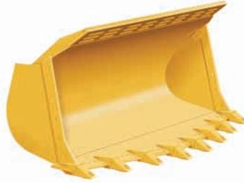
**Caçambas para rochas.** As caçambas para rochas são projetadas para carregamento de face ou de bancada em aplicações de mineração ou pedreiras. A caçamba de bordas retas para rochas proporciona força de desagregação mais elevada e aumento da altura livre de despejo. A caçamba para rochas com borda em forma de pá oferece melhor penetração.
