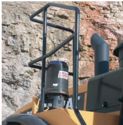
**Autolube.** O Sistema de Lubrificação Automática (Autolube) opcional proporciona uma lubrificação precisa, automática dos pinos e das buchas – enquanto a 980H está em operação. A lubrificação automática reduz o tempo gasto nas manutenções diárias e o tempo de máquina parada para reparos não planejados devido à lubrificação insuficiente – deixando mais tempo a cada dia para ser produtivo.
