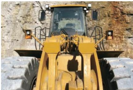
**Estruturas.** A 980H conserva as mesmas estruturas básicas da 980G Série II. O chassi completo do motor com seção em caixa absorve as cargas de choques e as forças de torção ao mesmo tempo que suporta o sistema propulsor para um alinhamento rígido dos componentes. O chassi tem mais de 90% das juntas soldadas por robôs, proporcionando soldas de penetração profunda para máxima durabilidade e resistência à fadiga.
