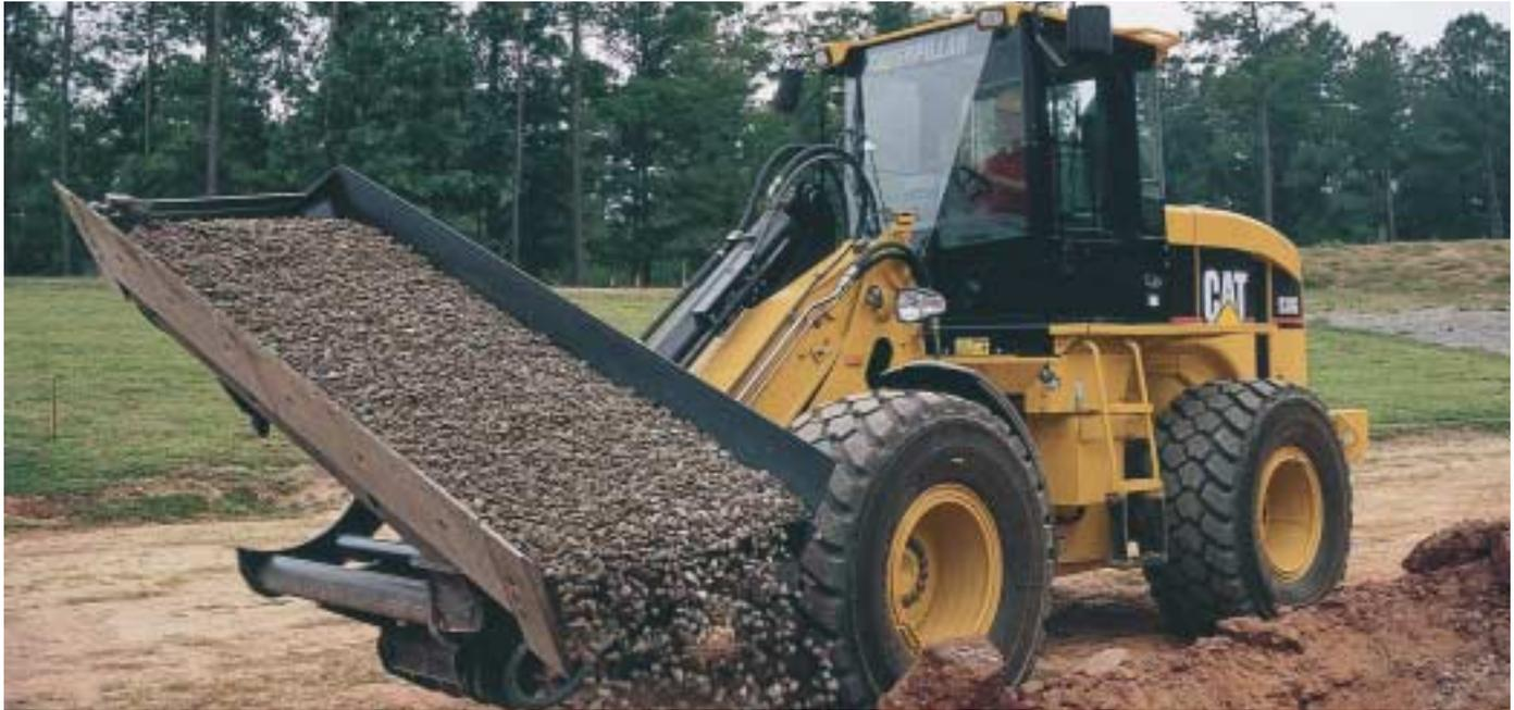
**Maniabilité.** Conçu par Caterpillar, le circuit hydraulique modulaire adoucit les commandes et les rend plus précises.
