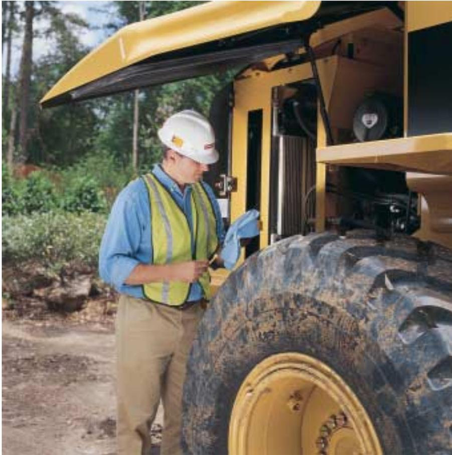
**Grande accessibilité.** Les portes relevables du carénage moteur et les jambes de force à gaz ouvrent largement accès aux filtres et aux points d'entretien. Le radiateur et les refroidisseurs d'huile sont facilement accessibles en vue du nettoyage.
