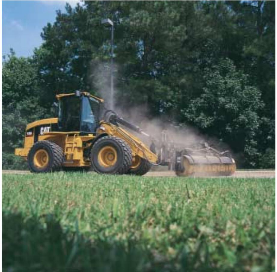
**Hydraulique auxiliaire.** Des ensembles pour troisième et quatrième fonctions hydrauliques sont offerts pour les outils de travail qui exigent la puissance de l'hydraulique comme les brosses rotatives ou les godets à grande hauteur de levage et à déversement latéral. Des ensembles pour 5e et 6e fonctions hydrauliques sont aussi offerts pour les travaux avec charrue et ailerons chasse-neige.
