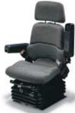
**Siège.** Le siège de série est en tissu ou en vinyle à réglages intégraux pour avancement et recul, inclinaison du siège, hauteur d'assise, angle des accoudoirs et suspension. Autres sièges offerts en option :
