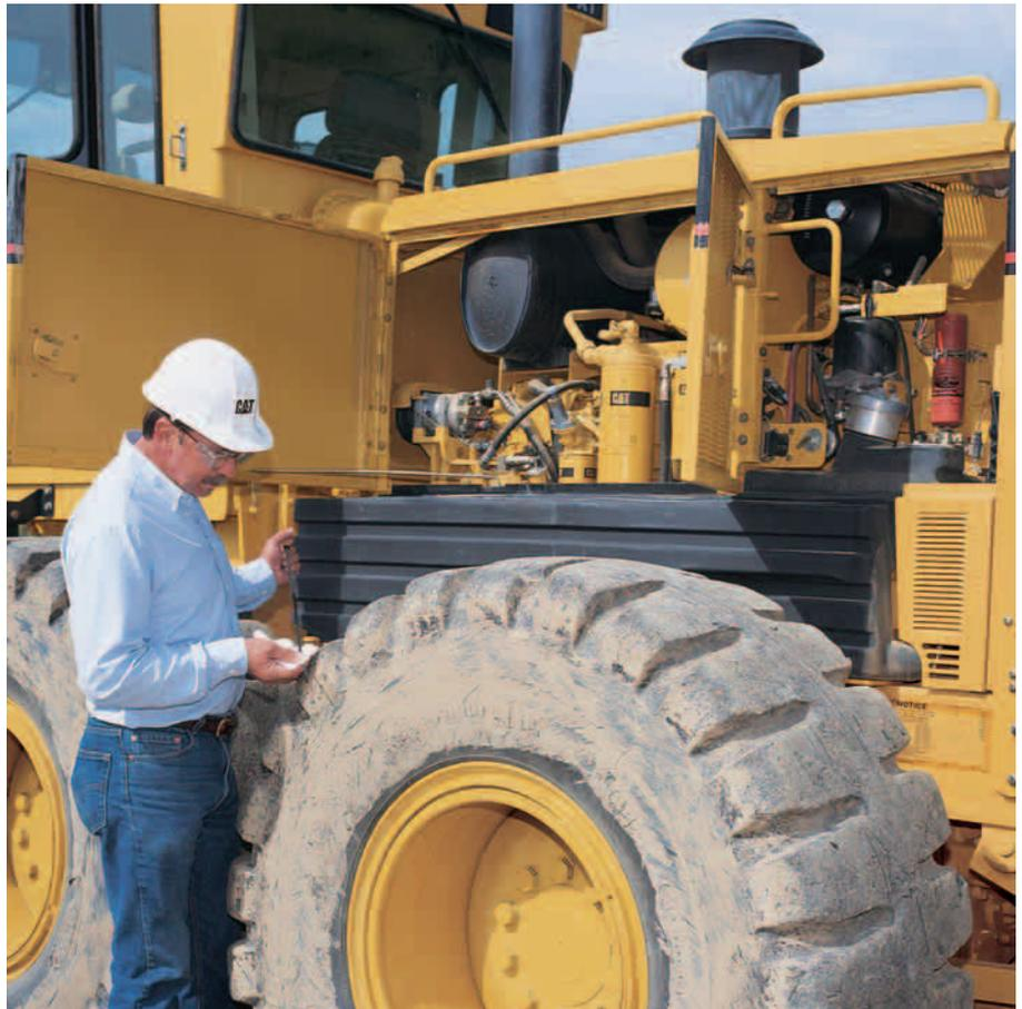
**Intervalle prolongé entre les vidanges d'huile.** 500 heures entre deux vidanges d'huile moteur et remplacements de filtre, 4000 heures entre les vidanges d'huile hydraulique. Les immobilisations sont réduites ainsi que les coûts d'utilisation.
