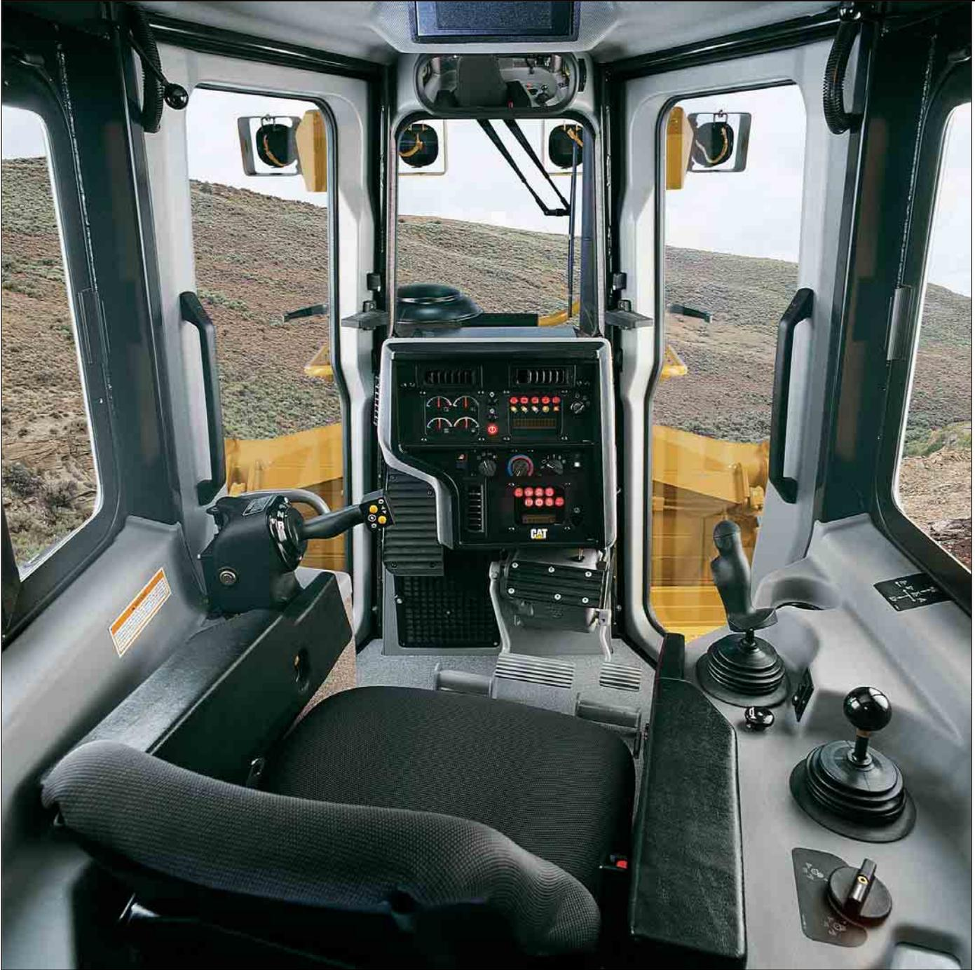
**Cabine.** Cabine pressurisée montée sur silentblocs réduisant le bruit et les vibrations pour un meilleur confort.
