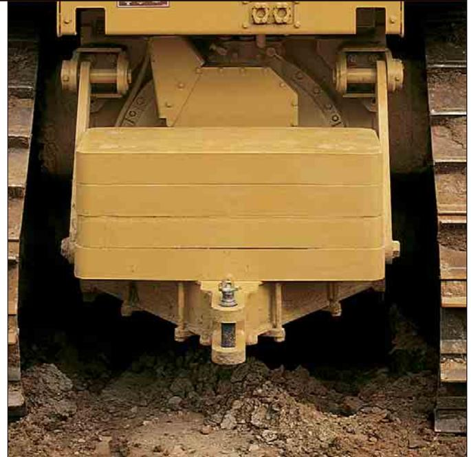
**Contrepoids arrière.** Les contrepoids arrière peuvent s'avérer nécessaires pour mieux équilibrer la machine lorsque celle-ci remonte une forte pente en marche arrière ou pour augmenter les performances lors du refoulement de gros volumes. Emploi conseillé en l'absence d'autres équipements arrière.
