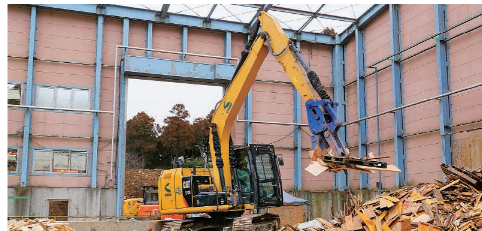
千葉中間処理工場で廃木材のリサイクルに活躍するCAT 312E (左) 廃木材は破碎装置で細かいチップに砕かれ、発電用の燃料として再利用されます(右)
