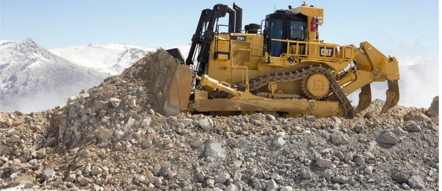
D10T2 提供两种采用 ACERT 技术的 C27 发动机。一种发动机符合 Tier 4 Final 排放标准，适合在对排放监管较为严格的国家/地区销售。另一种发动机符合 Tier 2 和 Stage II 等效排放标准，适合在对排放监管较为宽松或无限制的国家/地区销售。
