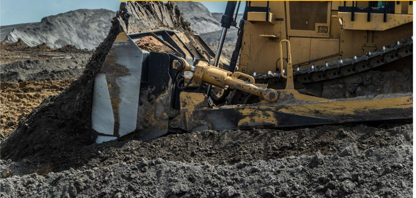
D10T2 配有经过现场验证的负载感应工装液压装置，它通过自动连续调节工装的液压功率来满足操作要求，从而改善燃油效率和机器性能。由于仅在发出工装命令时才会提供液压流量，因此履带获得更多的动力来推动机器前行，提高了推土机的性能。
