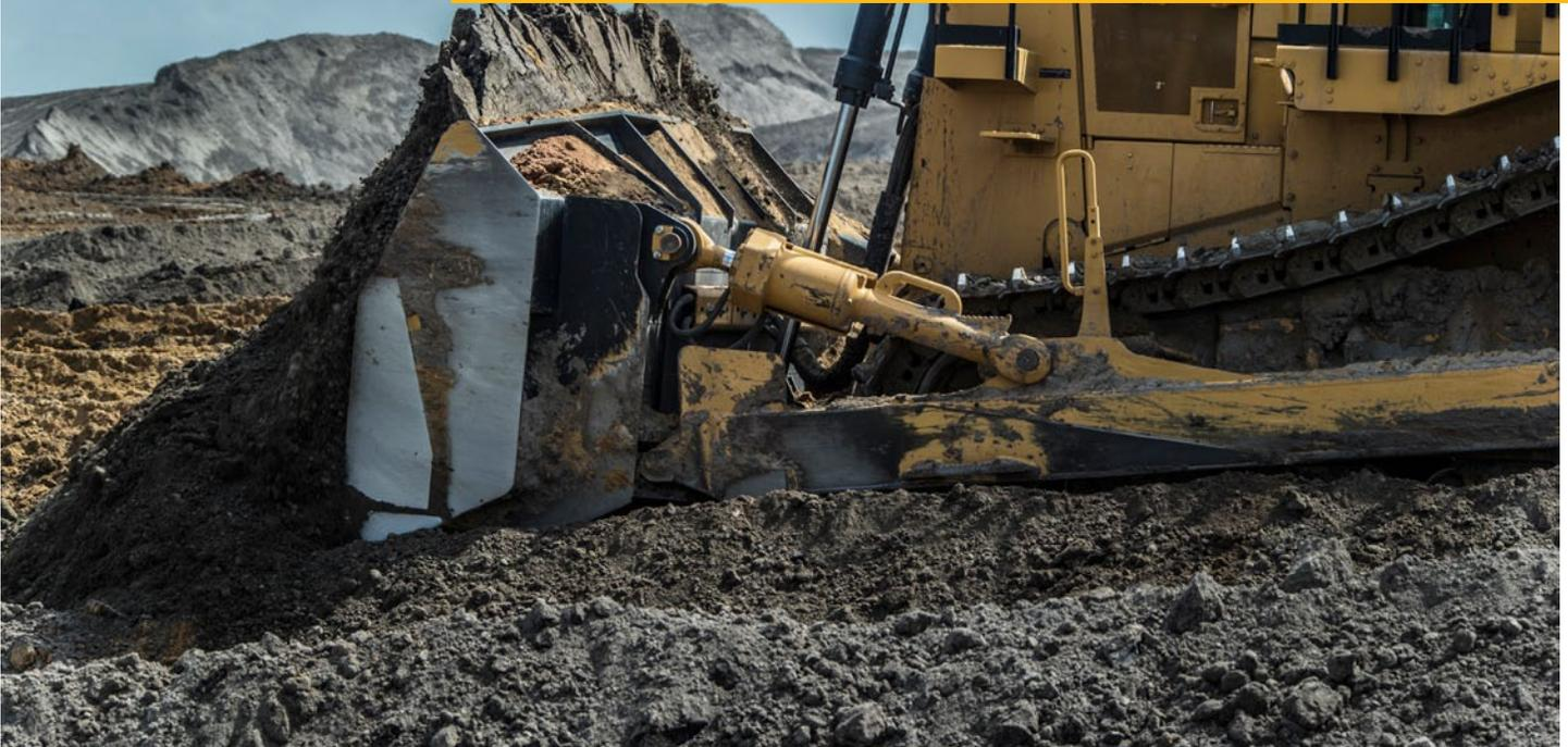
A eficiência de combustível e o desempenho são aprimorados com a hidráulica de implemento com detecção de carga do D10T2, que responde aos requisitos operacionais ajustando automática e continuamente a potência hidráulica do implemento. O desempenho do trator é melhorado, uma vez que o fluxo hidráulico é fornecido somente quando os comandos do implemento são feitos. Portanto, mais potência está disponível nas esteiras para mover a máquina para a frente.
