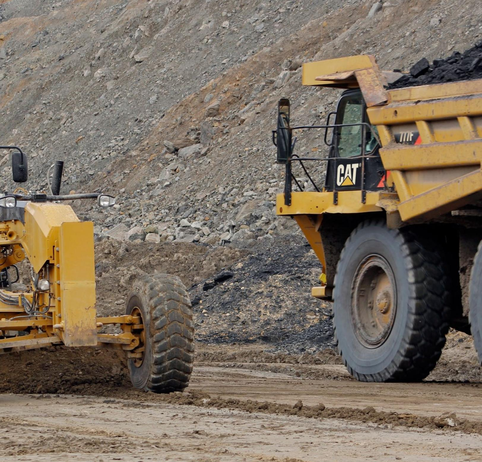
18M3では、駆動力をさらに高めるとともに、幅広のモールドボードを採用しているため、従来以上に効果的なブレード角度を使用できます。一度に整地できる幅が広く、運搬路の整地に必要な回数を低減し、作業効率を高めることができます。
