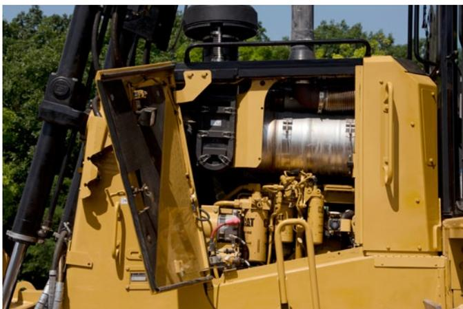
La tecnología de reducción de emisiones del modelo D8T está diseñada para ser transparente, sin que sea necesaria la actuación del operador. La regeneración se realiza automáticamente en segundo plano mientras trabaja.
