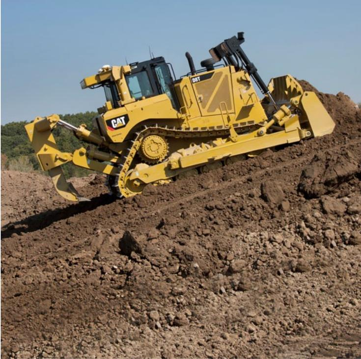
El D8T está construido sobre un resistente bastidor principal diseñado para absorber las altas cargas de impacto y las fuerzas de torsión. Un tren de rodaje totalmente suspendido proporciona más contacto con el suelo, especialmente en terrenos duros e irregulares. Mayor tracción significa menos patinaje, más equilibrio y una conducción más suave.
