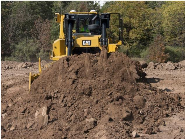
El diseño integral traslada las antenas a la parte superior de la cabina, lo que elimina los mástiles y cables que se ubicaban tradicionalmente en la hoja. El sistema de asignación 3D de las hojas y cadenas reduce la necesidad de colocar miras y piquetes de jalonamiento, mejora la seguridad y disminuye los costes en mano de obra.
