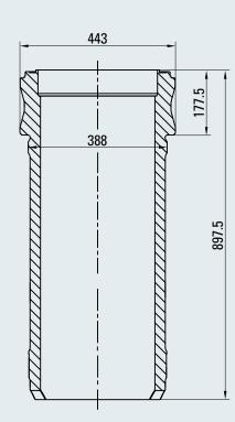
Fig. 21-5 Cylinder liner, weight 221 kg
