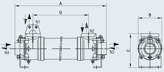
Fig. 5-22 Fuel oil cooler for MDO operation DH3
