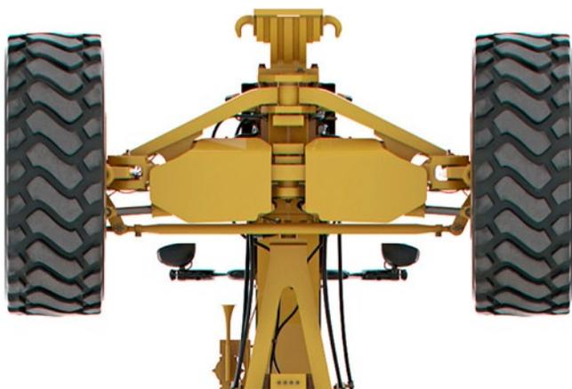
前轴转向油缸的设计增加了耐用性，并且液压软管布设合理，可提高可靠性。
