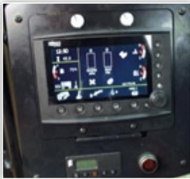
**Дисплей IQAN.** Дисплей IQAN позволяет оператору осуществлять непрерывный контроль за работой операционных систем машины. Тем самым обеспечивается раннее оповещение о возможных проблемах, и у оператора появляется возможность максимально увеличить показатели работы и производительность.
