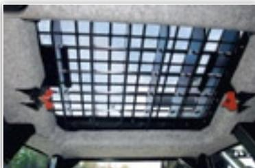
**Верхний люк.** Уникальный большой поликарбонатный световой люк обеспечивает прекрасный вертикальный обзор и служит запасным аварийным люком.
