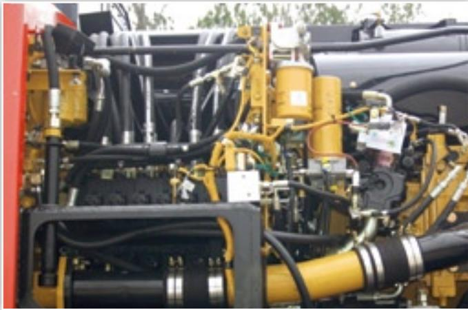
**Высокие показатели работы.** Регулируемый при помощи электронного оборудования ACERT двигатель Cat C9 обеспечивает работу в соответствии со всеми действующими требованиями стандарта Tier II по вредным выбросам. Все модели оснащены водоотделителем для топлива, подогревателем поступающего воздуха и двухступенчатым комбинированным воздухоочистителем с предварительной очисткой.
