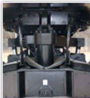
**Дорожный просвет.** Машины ZTS обладают превосходным дорожным просветом и конструкцией кузова открытого типа. Это обеспечивает повышенную мобильность за счёт устранения помех, вызываемых лесосечными отходами и другими препятствиями, существующими в тяжёлых условиях работы.
