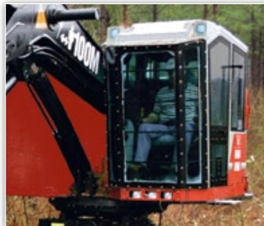
**Обзор.** Конструкция кабины оптимизирована, а расположение стекол обеспечивает оператору прекрасный передний, боковой и задний обзор. Кабина для лесозаготовок оснащена ограждением, предназначенным для тяжелого режима работы, и соответствует требованиям FOPS/ROPS/OPS.
