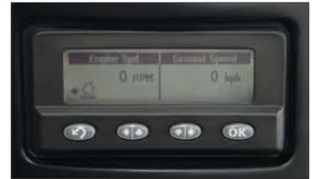
**Cat Messenger.** De série na 120M, o Cat Messenger oferece dados de desempenho da máquina e de diagnóstico em tempo real com um interface fácil de utilizar. O Messenger monitoriza todos os dados do sistema e alerta o operador para qualquer avaria através de um visor digital com texto que pode ser exibido em vários idiomas.
