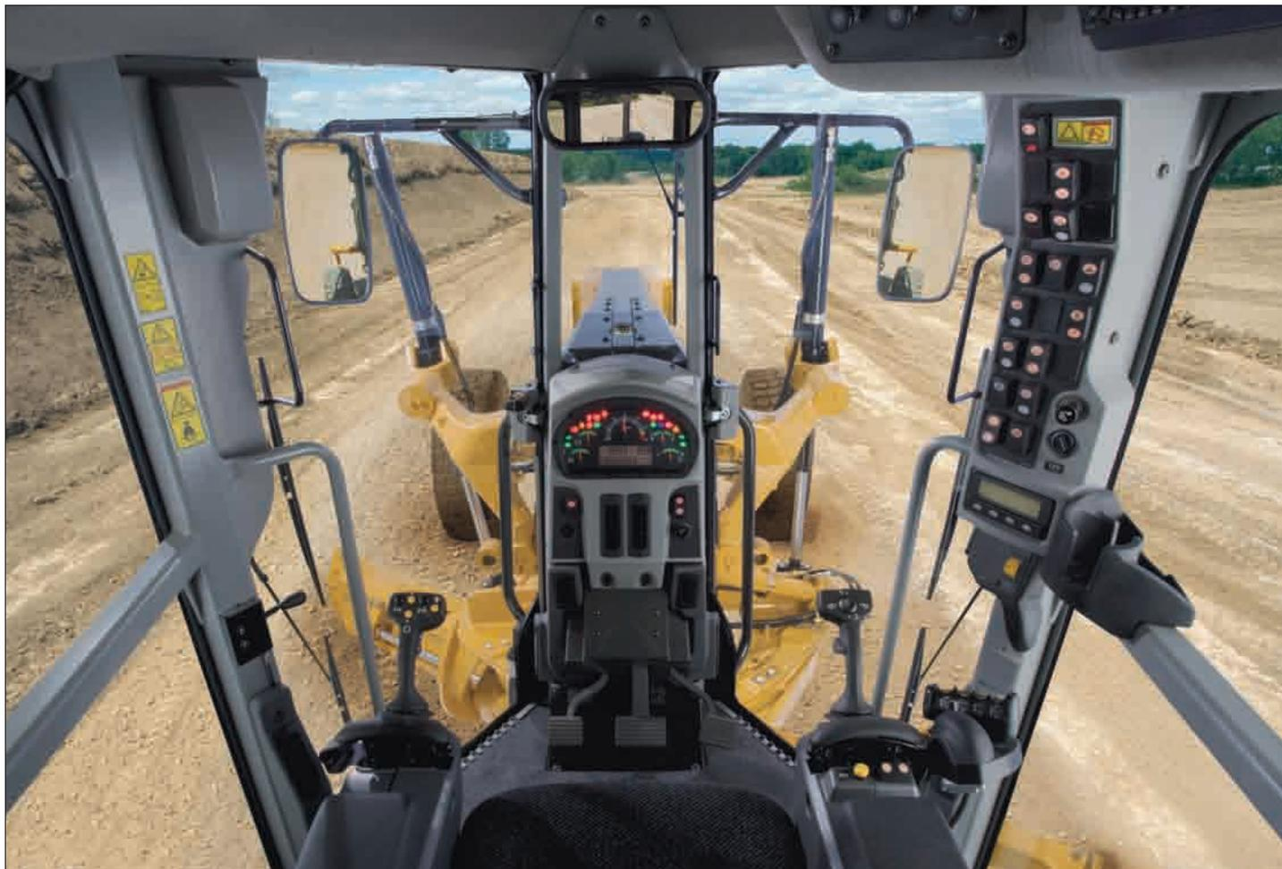
**Comandos avançados por punhos de comando (joysticks).** Dois punhos de comando electro-hidráulicos reduzem até 78% dos movimentos da mão e do pulso em comparação com os comandos de alavanca normais para uma melhor eficiência do operador. O padrão intuitivo de manobra é fácil de aprender e proporciona o controlo preciso do acessório que se espera da Caterpillar.
