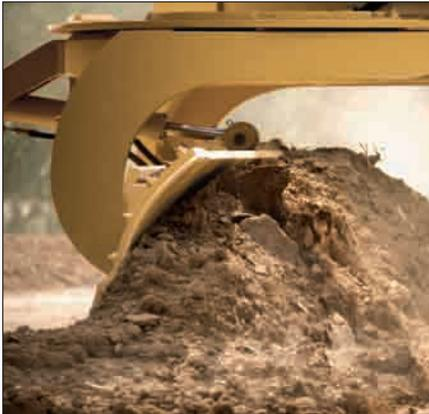
**Escarificador traseiro.** O escarificador opcional da 120M foi construído para penetrar rapidamente no material duro e escarificar cuidadosamente, facilitando a movimentação do material com o arado de aiveca. O escarificador inclui três dentes com possibilidade de acrescentar mais dois, se for necessário.
