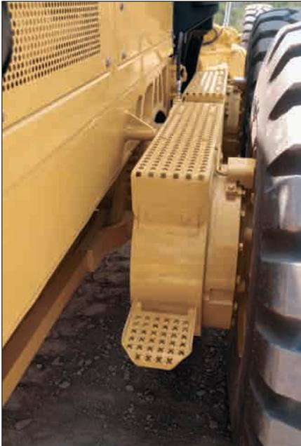
**Passadiços tandem em aço.** Passadiços em aço perforados e sobrelevados cobrem o tandem. Isto proporciona uma plataforma robusta para estar de pé e andar pela máquina e é uma protecção adicional para o sistema de travagem.
