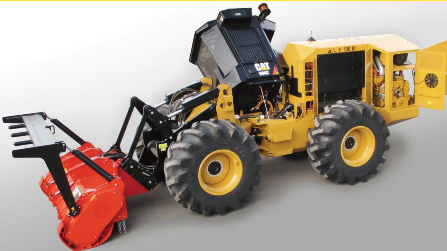
Удобный доступ к точкам ежедневного обслуживания на 586С. Доливайте гидравлическое масло при помощи электрического насоса и заправляйте машину топливом, стоя на твердом грунте. Откидная кабина и навесные панели обеспечивают простой доступ к еще большему количеству компонентов.
