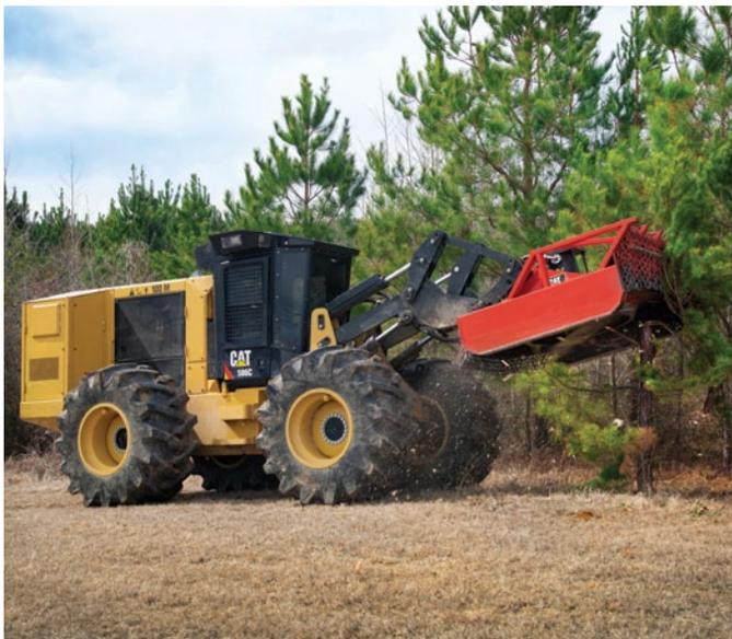
Ядром гидросистемы машины 586С является новая система PowerDirect Plus, которая не только выполняет регулировку мощности по нагрузке, но и эффективно распределяет мощность между всеми системами для повышения их возможностей и производительности.
