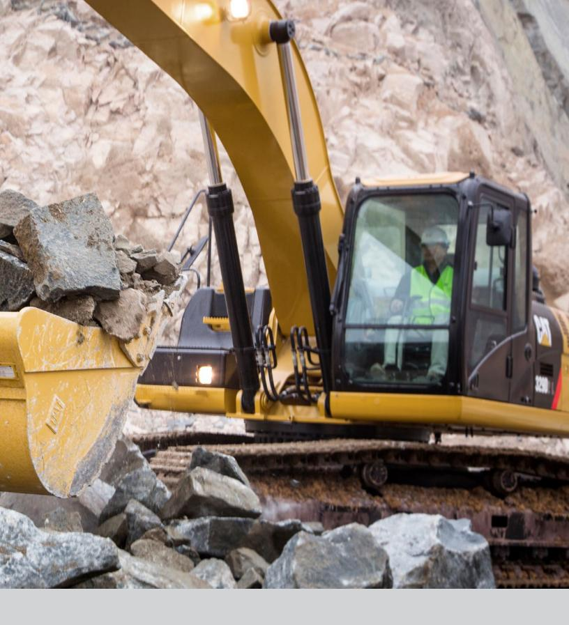
Le modèle 329D2/D2 L est doté d'un certain nombre de perfectionnements et de nouvelles fonctionnalités pour vous aider à tirer le meilleur parti de votre machine. Commande de régime moteur isochrone, nouveau système de filtration du carburant, un mode économie intégré permettant d'économiser jusqu'à 11 % de carburant et d'énergie. Un ventilateur à vitesse variable à visco-coupleur rend cette machine plus productive, plus efficace et plus sûre.
