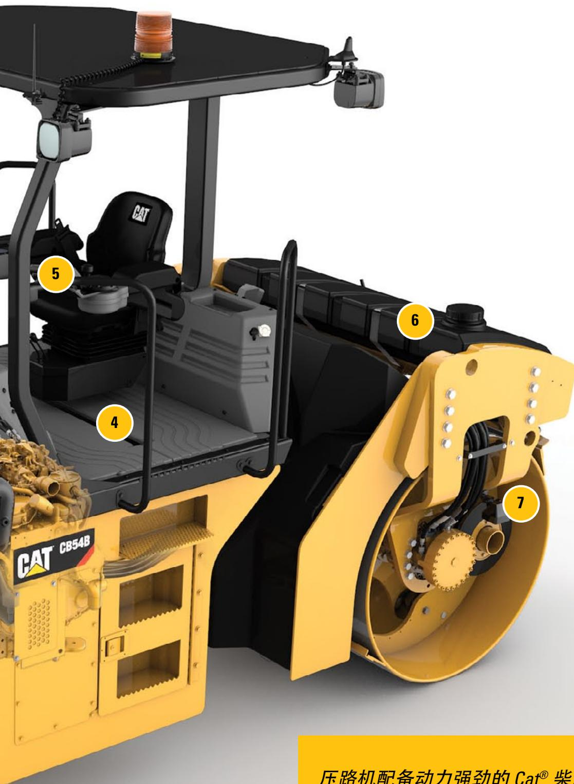
压路机配备动力强劲的 Cat® 柴油发动机，功率范围在 82.1 kW (110 hp 英制, 111.6 hp 公制) 和 96.5 kW (129 hp 英制, 131.2 hp 公制) 之间。
