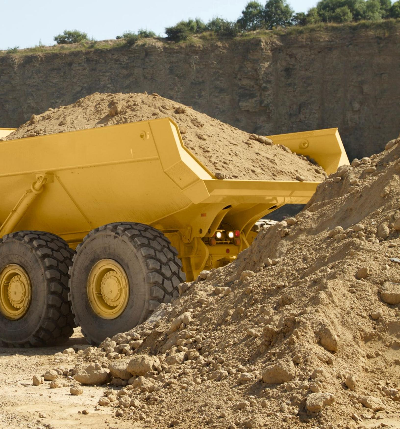
Cat 735C 的容量高达  $22 \text{ m}^3$  ( $28.7 \text{ yd}^3$ ) /32.7 公吨 (36 短吨)，并且具有久经考验的可靠性、耐用性、高生产率、卓越的操作舒适性及更低的运营成本。
