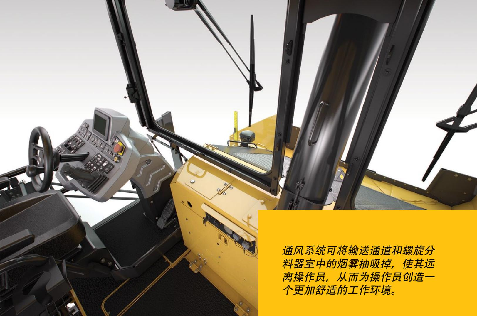
通风系统可将输送通道和螺旋分料器室中的烟雾抽吸掉，使其远离操作员，从而为操作员创建一个更加舒适的工作环境。
