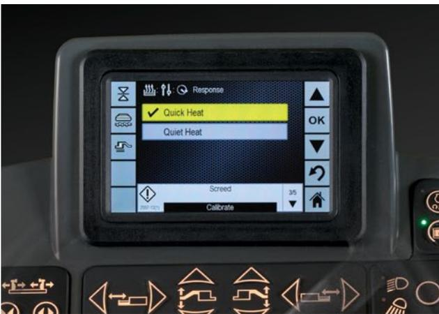
通过 LCD 显示器轻松设置安静或快速加热。使用宽型套件时快速加热，节省时间。
