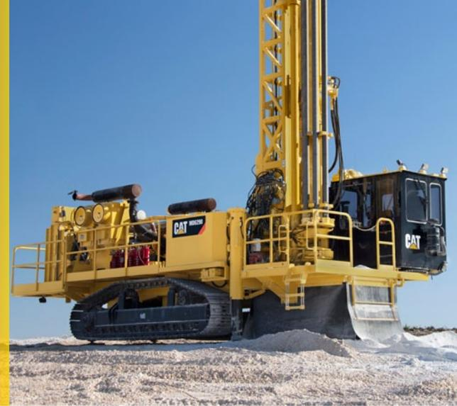
***Plébiscitée par les entrepreneurs, la MD6290 fore des trous d'un diamètre allant de 152 à 241 mm avec une force de charge d'outil jusqu'à 23 373 kg . La MD6290 permet de forer à des profondeurs pouvant atteindre 52,7 m. La MD6290 Cat® est une sondeuse dotée d'un moteur diesel, équipée d'une tête rotative de qualité pour les applications de forage de fond de trou (DTH, Down The Hole) rotatives et à haute pression.***
