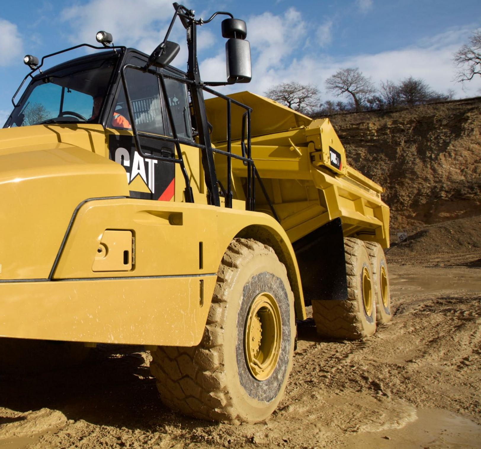
**Cat 740C EJ dengan kapasitas 23 m<sup>3</sup> (30,1 yd<sup>3</sup>) 38 metrik ton (42 ton) menawarkan keandalan yang telah teruji, ketahanan, produktivitas tinggi, kenyamanan operator yang sangat baik, dan biaya pengoperasian yang lebih rendah.**
