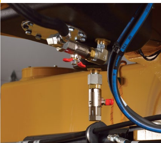
Válvulas de drenaje agrupadas
