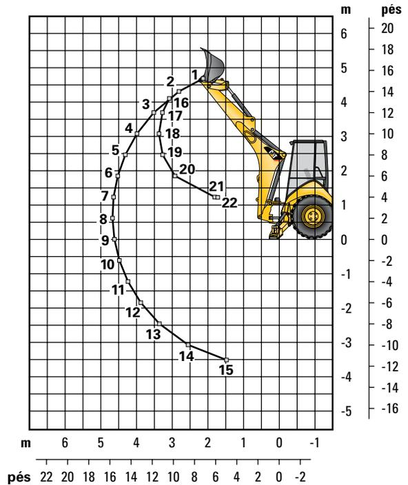
As Capacidades de Levantamento têm valores excedentes. Máquina equipada com tração nas 4 rodas, OROPS, caçamba de propósito geral de 0,96 m<sup>3</sup> (1,25 yd<sup>3</sup>) e sem contrapeso. O braço extensível inclui contrapeso de 460 kg (1.015 lb).
