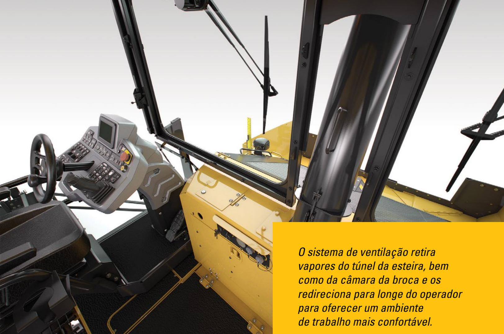
*O sistema de ventilação retira vapores do túnel da esteira, bem como da câmara da broca e os redireciona para longe do operador para oferecer um ambiente de trabalho mais confortável.*
