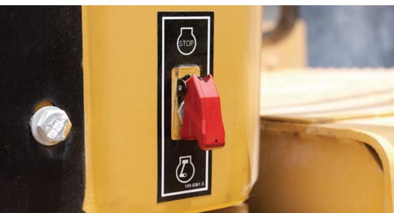
Seu caminhão Cat da Série G foi projetado para fornecer aos operadores e técnicos fácil acesso a pontos de manutenção comuns, como travamento do motor, travamento do sistema da máquina, visores de nível de fluido, graxeiros e acesso ao motor para manutenção regularmente programada.
