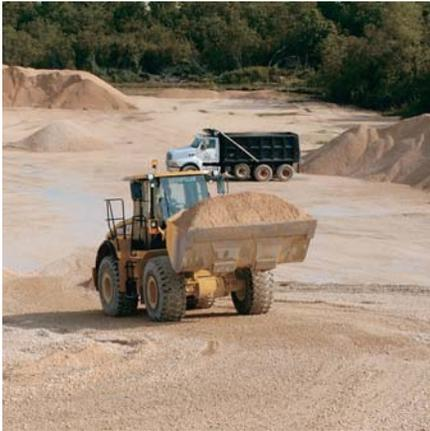
**COMMANDE ANTITANGAGE** La commande antitangage en option adoucit les déplacements et améliore la performance et la retenue de la charge en déplacement sur terrain accidenté. Le conducteur peut rouler plus vite en toute confiance en chargement-transport, diminuant les temps de cycle et augmentant la productivité.
