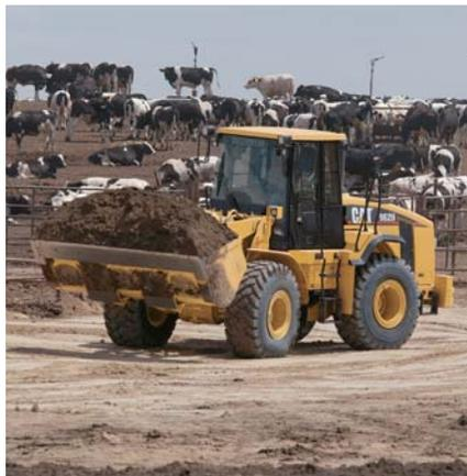
**TRANSMISSION POWERSHIFT** Le 962H profite de la technologie éprouvée de la transmission powershift extra-robuste des modèles antérieurs, qui équipe maintenant les plus gros chargeurs sur pneus Caterpillar, et ce, jusqu'au modèle 994F.
