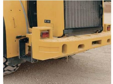
**Contrepoids** Le contrepoids monopièce est intégré à la conception et au style du 962H. Les phares arrière sont incorporés au sommet de la structure de ce contrepoids de 1399 kg (3084 lb).
