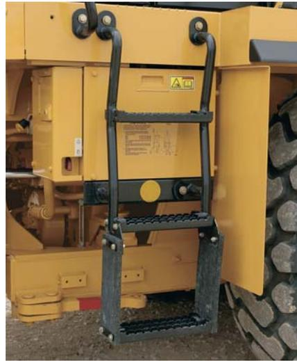
**ENTRÉE ET SORTIE** Le marchepied autonettoyant réduit au minimum l'accumulation de débris. Il est incliné de 5° vers l'avant pour faciliter l'entrée et sortie.
