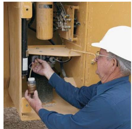
**SERVICES S•O•S** Les robinets de prélèvement d'échantillons du 962H accélèrent le prélèvement des huiles (moteur, transmission et hydraulique) à des fins d'analyse S•O•S. Les intervalles de changement d'huile et des autres interventions d'entretien peuvent être adaptés à votre horaire, réduisant ainsi vos immobilisations et vous aidant à gérer vos dépenses..
