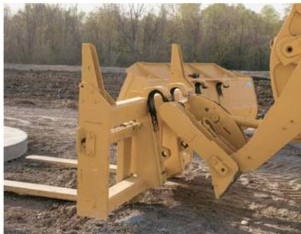
**Coupleurs express** Les coupleurs express fournissent aux chargeurs sur pneus une polyvalence sans pareille. Le modèle hydraulique permet au conducteur de changer les accessoires en quelques secondes sans pour autant quitter la cabine. Avec le modèle manuel, le conducteur doit verrouiller les axes.
