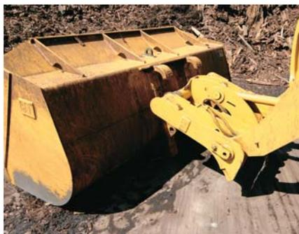
**Godets normaux** Les godets normaux procurent une bonne performance générale pour la mise en tas, la reprise, le creusage et le chargement de matériaux en place. On peut utiliser un godet normal extra-robuste pour les applications plus exigeantes.
