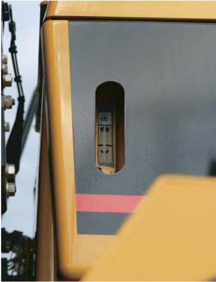
**REGARDS DE NIVEAU** Les regards de niveau d'huile (transmission et hydraulique) et du liquide de refroidissement du radiateur, bien protégés mais bien visibles, facilitent la vérification quotidienne et réduisent la pénétration des contaminants.
