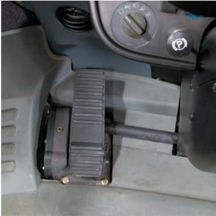
**Circuit de freinage intégré** Le circuit de freinage intégré exclusif de Cat réduit la température de l'huile d'essieu et adoucit la neutralisation de la transmission. L'IBS agit directement sur la durabilité des essieux et des freins, surtout dans des applications nécessitant de longues distances et/ou un freinage intense.
