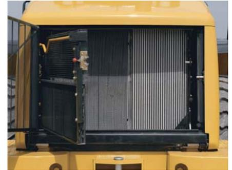
**CIRCUIT DE REFROIDISSEMENT** Le circuit de refroidissement est remarquablement accessible au nettoyage et à l'entretien. La grille ondulée et perforée réduit au minimum l'accumulation de débris; elle pivote vers l'extérieur pour faciliter le nettoyage et l'entretien des faisceaux de refroidissement.
