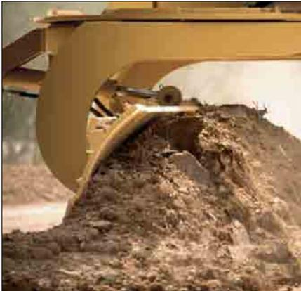
**Ripper arrière.** Le ripper en option de la 120M est conçu pour pénétrer rapidement dans les matériaux durs et garantir un rippage efficace afin de faciliter le déplacement de la lame dans le matériau. Le ripper comprend trois dents avec la possibilité d'en ajouter deux autres au besoin.
