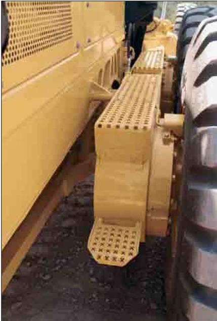
**Passerelles de tandem en acier.** Des passerelles en acier perforé en relief recouvrent les tandems. Cela procure à la fois une solide plate-forme sur laquelle on peut se tenir ou se déplacer et une protection supplémentaire pour les canalisations de frein.
