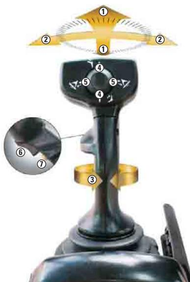
**Fonctions du joystick droit.** Le joystick droit commande essentiellement les fonctions du bâti de cercle, du cercle et de la lame.
