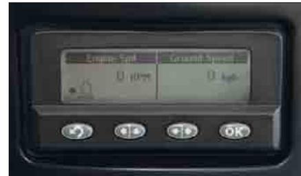
**Cat Messenger.** Le système Cat Messenger, de série sur la 120M, fournit en temps réel des données de diagnostic et de performances de la machine via une interface très simple. Messenger surveille toutes les données relatives aux circuits et avertit le conducteur de toute anomalie par l'intermédiaire d'un affichage numérique de texte disponible en plusieurs langues.
