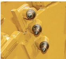
**Die Platzierung der Dreiergruppen-Fräsmeißel am Rotorende räumt loses Material weg und verringert den durch Rangieren in der Fräsbahn entstehenden Verschleiß am Rotor.**
